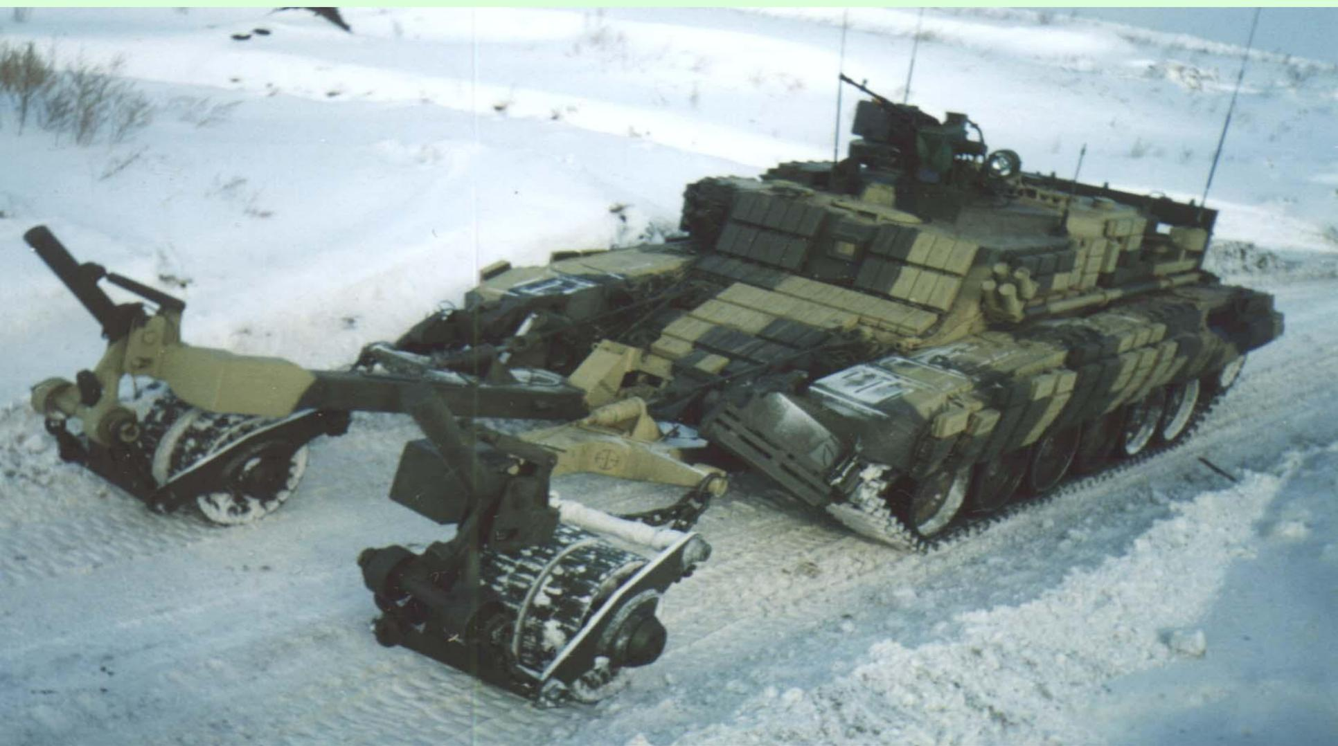
Бронированная машина разминирования БМР-3М
