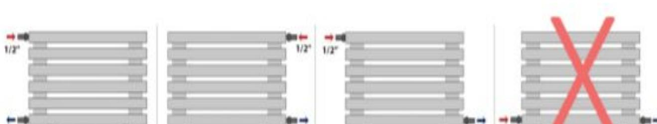
Боковое подключение для горизонтального положения или нижнее по краям. 4 отверстия 1/2"
