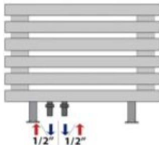
Нижнее левостороннее подключение (горизонтальное расположение). 2 отверстия снизу 1/2" под мультифлекс, межросевое расстояние 50 мм). 1 отверстие сверху под воздухоотводчик 1/2".
