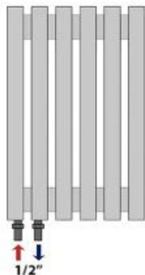
NK-VER-L\R Нижнее лево/право стороне подключение (вертикальное расположение). 2 отверстия снизу 1/2" под мультифлекс, межосевое расстояние 50 мм). 1 отверстие сверху под воздухоотводчик 1/2".
