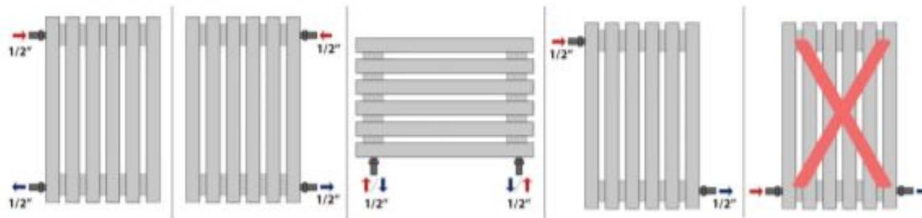
Боковое подключение для вертикального расположения расположения секций. 4 отверстия 1/2"
