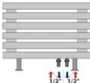
Нижнее правостороннее подключение (горизонтальное расположение). 2 отверстия снизу 1/2" под мультифлекс, межросевое расстояние 50 мм). 1 отверстие сверху под воздухоотводчик 1/2".
