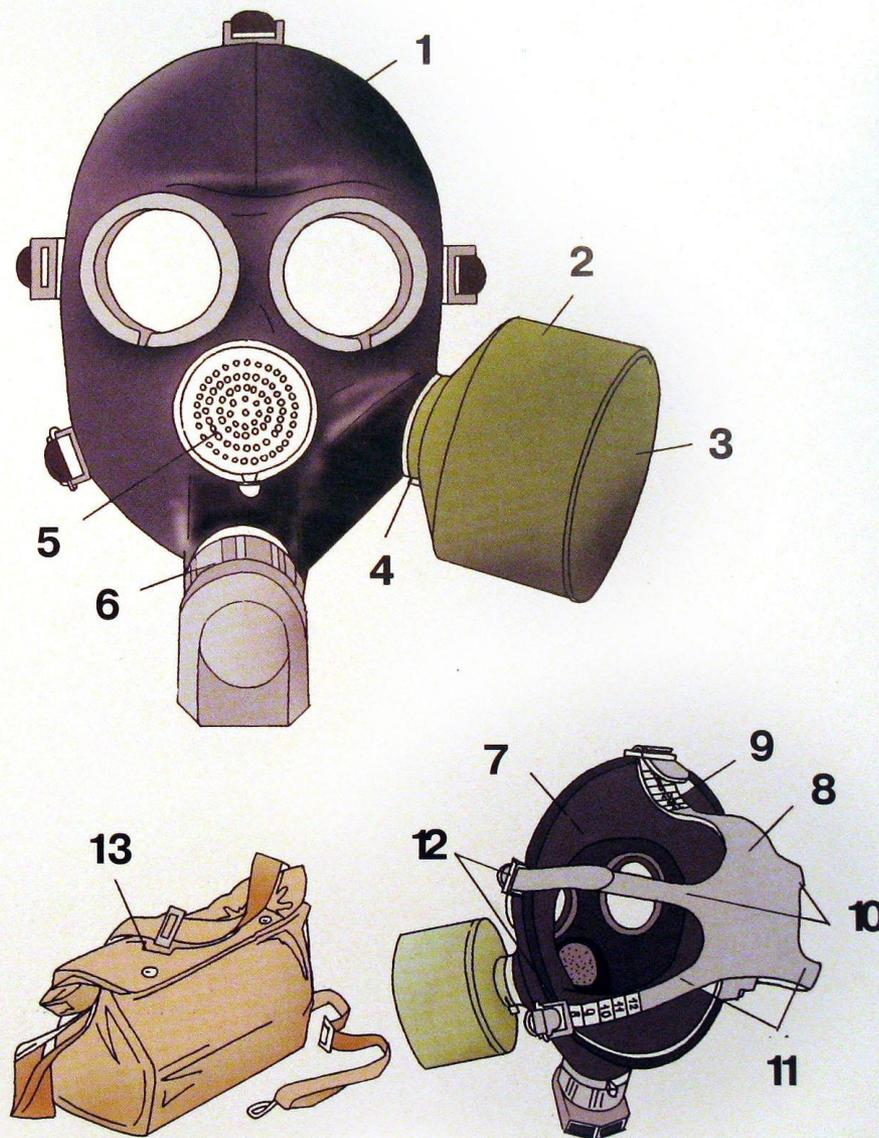
**Гражданский противогаз ГП-7** предназначен для защиты от попадания в органы дыхания, в глаза и на лицо человека отравляющих и радиоактивных веществ в виде паров и аэрозолей, бактериальных (биологических) средств:
