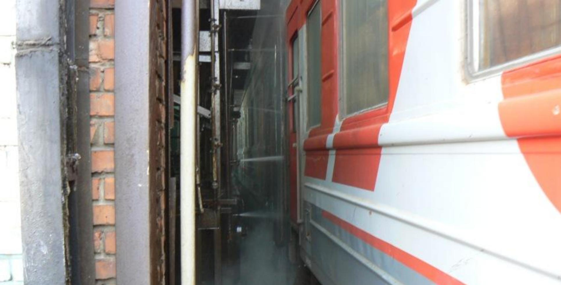
Предварительное опрыскивание в летний период, т.к. рабочая поверхность нагревается до 70 градусов по цельсию. И согревание в зимний период для доведения температуры до +5-10 градусов по цельсию. Нанесение кислотного рабочего раствора с помощью форсунок на предварительно охлажденный, или согретый кузов железнодорожного вагона.
