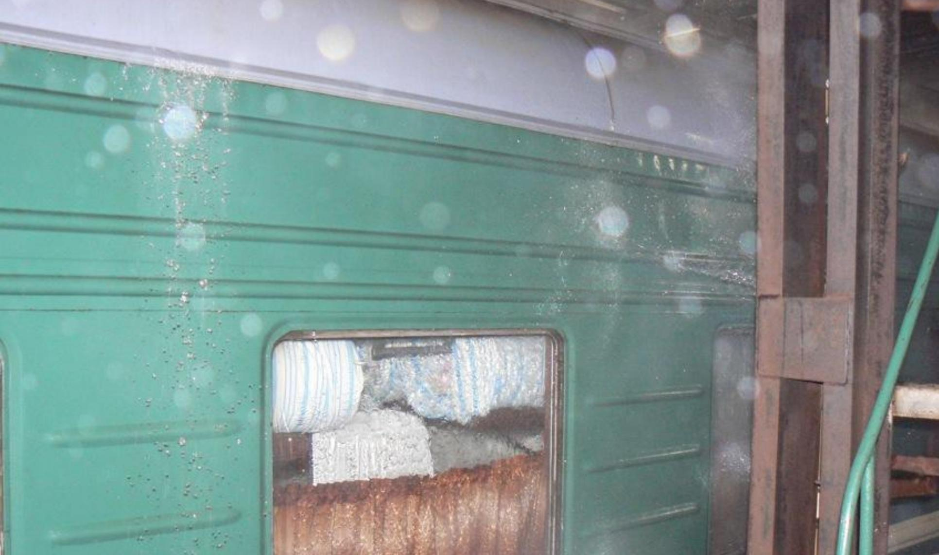
Смывка кислотного рабочего раствора с крыши и поверхности железнодорожного вагона, после механизированной растирки рабочего раствора щетками.
