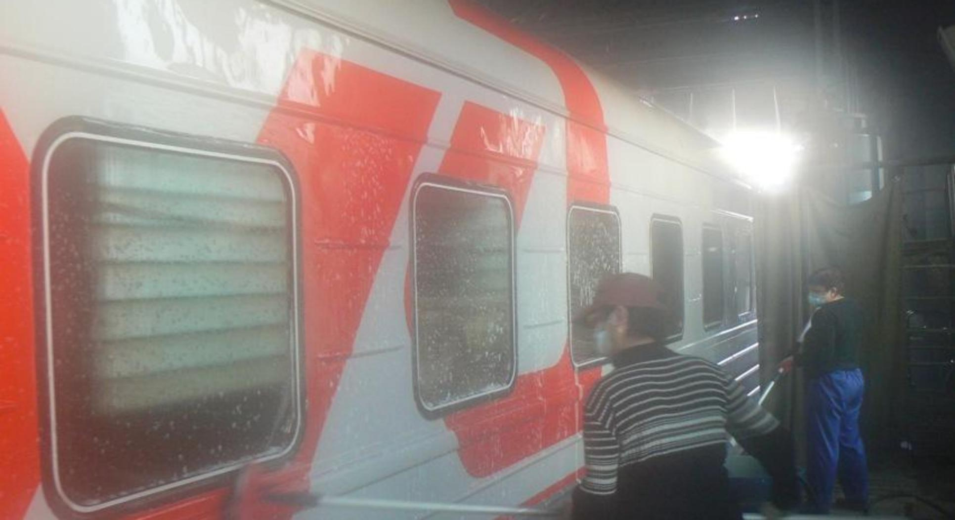
Ручное растирание кислого (кислотного) моющего рабочего раствора по наружной поверхности пассажирского вагона, после нанесения раствора с помощью форсунок. Надо заметить, что состав по технологии непрерывно движется со скоростью 5 км/час.
