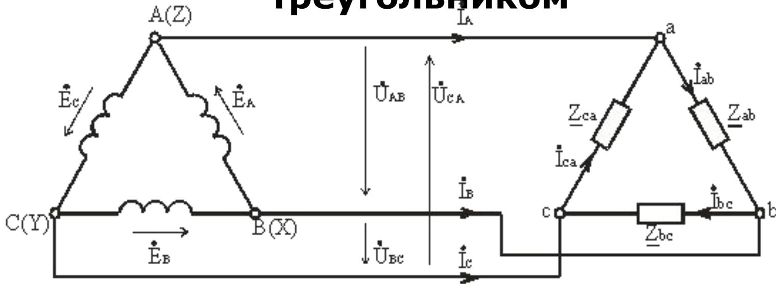
Соединение фаз источника в замкнутый треугольник возможно при симметричной системе ЭДС, так как (3.17)
