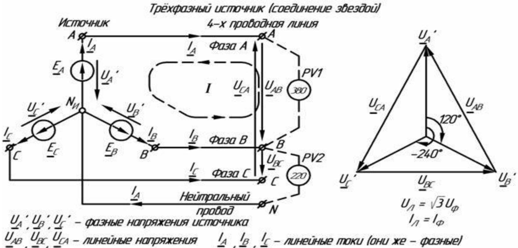
Напряжения на фазах источника  $U_{\phi_A}$ ,  $U_{\phi_B}$  и  $U_{\phi_C}$ , а также токи  $I_{A'}$ ,  $I_{B'}$ ,  $I_{C'}$  в этих фазах принято называть **фазными**.
