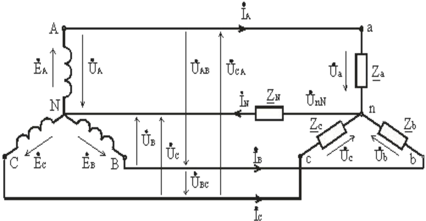
Провода А-а, В-в и С-с, соединяющие начала фаз генератора и приемника, называются линейными, провод N-n, соединяющий точку N генератора с точкой n приемника, – нейтральным.
