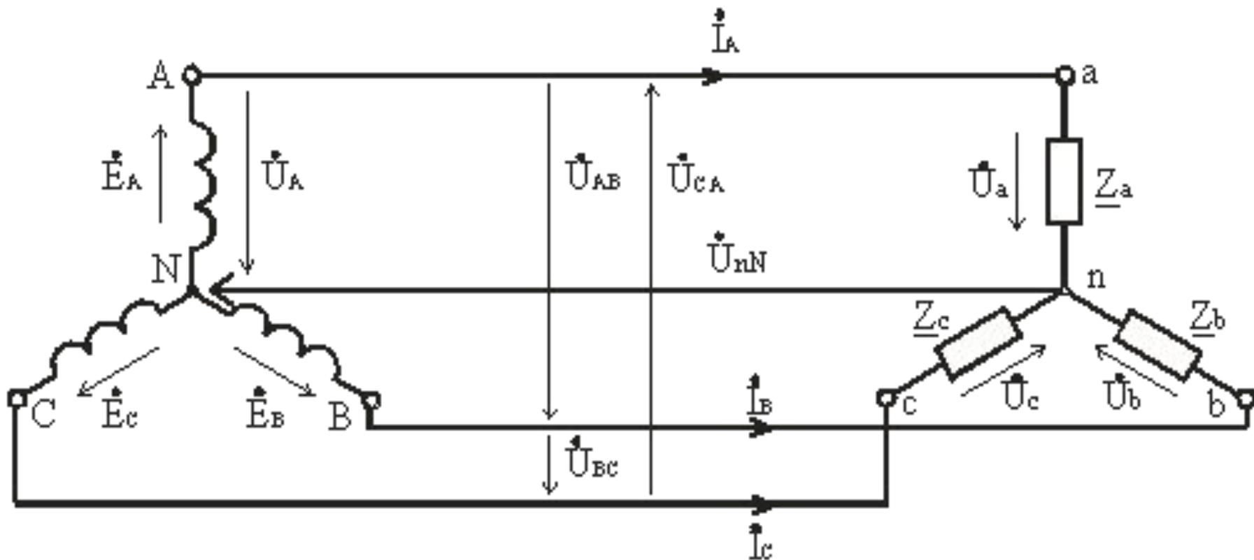
При симметричной нагрузке, когда  $\underline{Z}_a = \underline{Z}_b = \underline{Z}_c = Z_\phi$ , напряжение между нейтральной точкой источника N и нейтральной точкой приемника n равно нулю,  $U_{nN} = 0$ . При несимметричной нагрузке  $\underline{Z}_a \neq \underline{Z}_b \neq \underline{Z}_c$  между нейтральными точками приемника и источника электроэнергии возникает напряжение смещения нейтрали  $U_{nN}$ .
