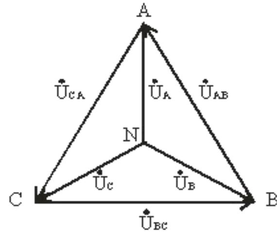
Согласно этим <sup>а)</sup> выражениям на рис. 3.7а <sup>б)</sup> построена векторная диаграмма, из которой видно, что при симметричной системе фазных напряжений система линейных напряжений тоже симметрична:  $U_{AB}, U_{BC}, U_{CA}$  равны по величине и сдвинуты по фазе относительно друг друга на  $120^\circ$  (общее обозначение  $U_L$ ), и опережают, соответственно, векторы фазных напряжений  $U_A, U_B, U_C$ , ( $U_\Phi$ ) на угол  $30^\circ$ .
