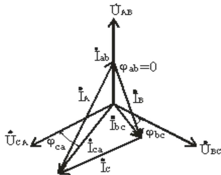
Важной особенностью соединения фаз приемника треугольником является то, что при изменении сопротивления одной из фаз режим работы других фаз остается неизменным, так как линейные напряжения генератора являются постоянными. Будет изменяться только ток данной фазы и линейные токи в проводах линии, соединенных с этой фазой. Поэтому схема соединения треугольником широко используется для включения несимметричной нагрузки.
