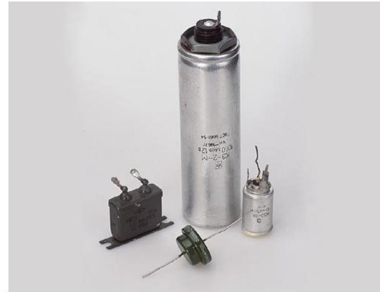
**Конденсатор постоянной емкости**
