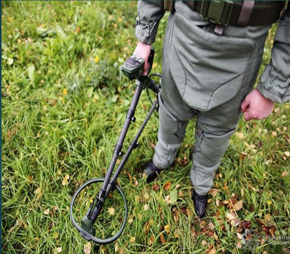
Разработан на замену действующих миноискателей ИМП, стоящих на вооружении сегодня. Прибор предназначен для обнаружения противопехотных и противотанковых мин, корпус, взрыватели и детали которых изготовлены из металла.
