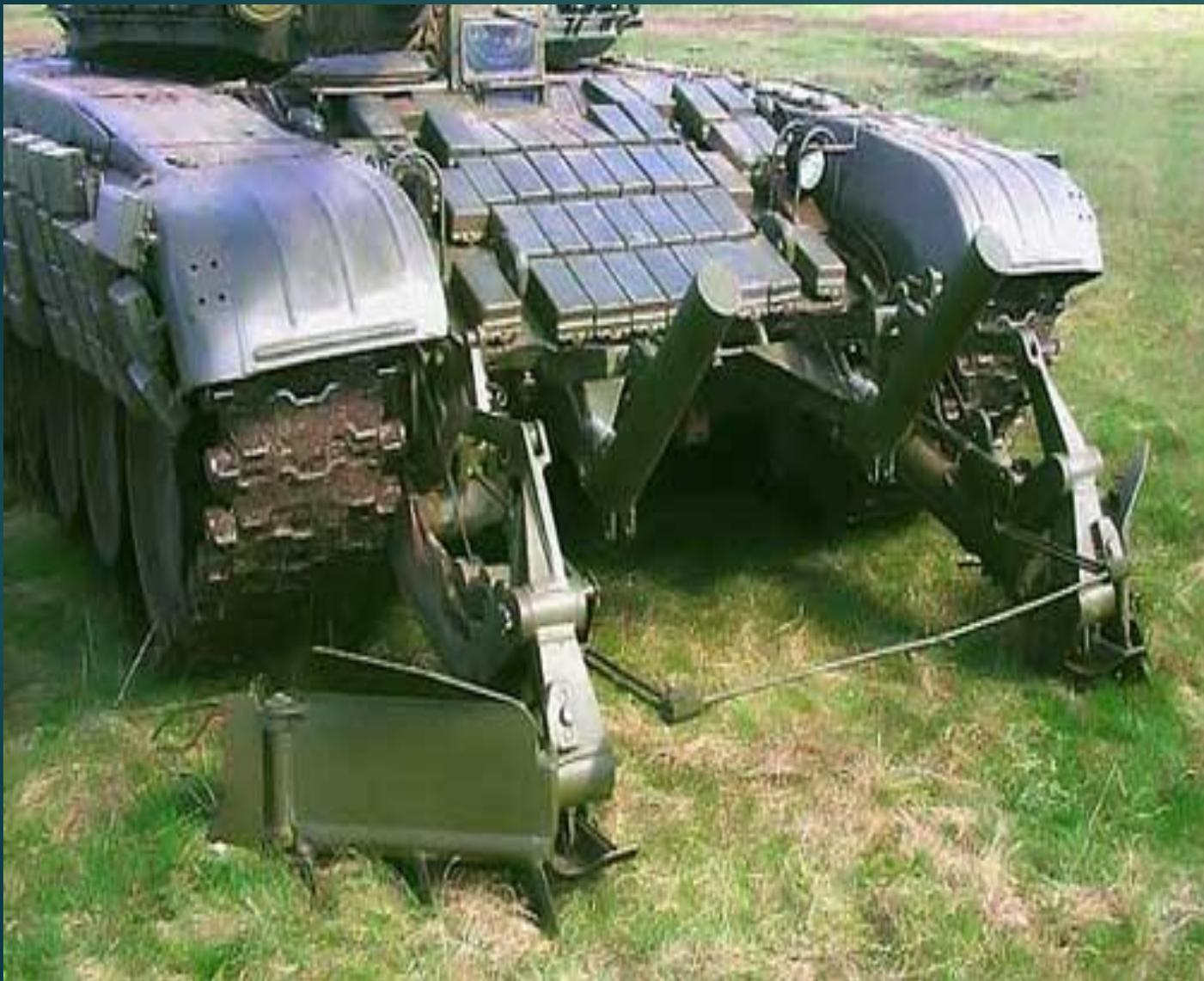
Является навесным оборудованием на танк и предназначен для обеспечения преодоления танком минных полей из противотанковых мин. Трал является индивидуальным средством и не предназначен для проделывания проходов в минных полях для других танков.
