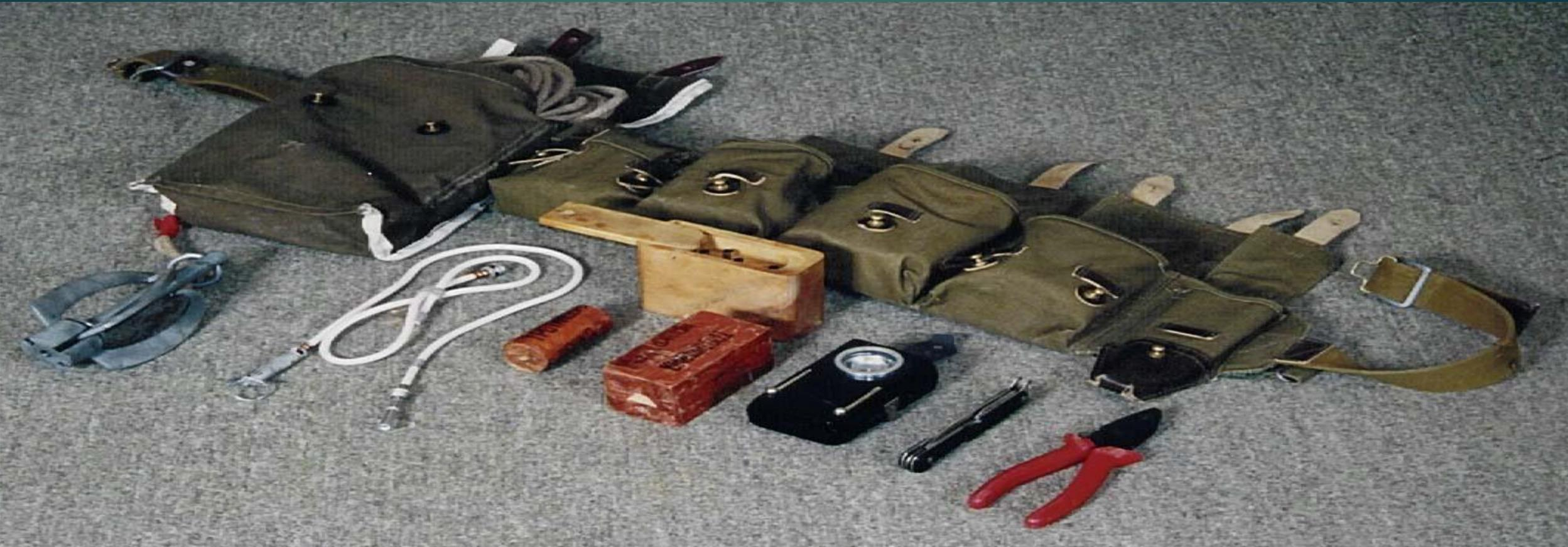
**ВКР-2 предназначен для применения нештатными группами при проделывании ими проходов в дистанционно установленных минных полях.**
