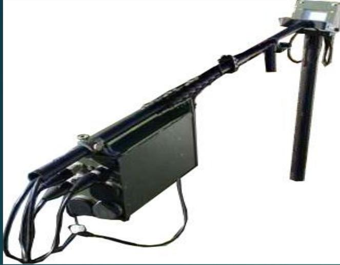
Переносной прибор служит для определения местонахождения ферромагнитных мин, фугасных бомб и невзорвавшихся снарядов в земле и в воде. Посредством этого прибора обнаруживаются невзорвавшиеся бомбы и гранаты, трубопроводы и кабельные муфты, оружие и другие ферромагнитные предметы. В случае водного варианта использование поискового зонда возможно до глубины воды 30 м.
