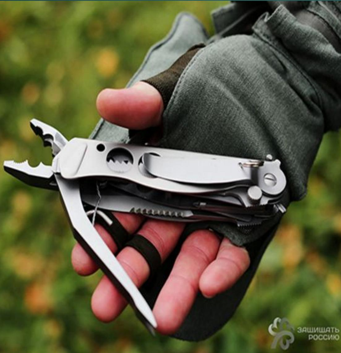
Нож предназначен для оснащения военнослужащих Сухопутных войск, ВДВ, морской пехоты и спецназа. У ножа есть: специализированный клинок, универсальная пила, шило, пассатижи, плоская шлицевая отвертка, отвертка для работы с крестообразным шлицом. Вес комплекта –400 грамм.
