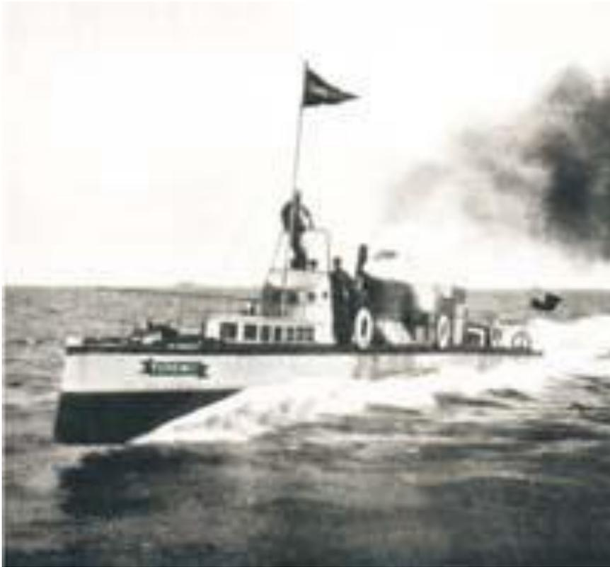
Первое судно с паротурбинным двигателем – «Турбиния», - построенное Парсонсом в 1894 году развивало скорость около 59 км/час. С 1900 года турбины начали устанавливать на миноносцах, а после 1906 года все большие военные корабли оснащались турбинными двигателями.
