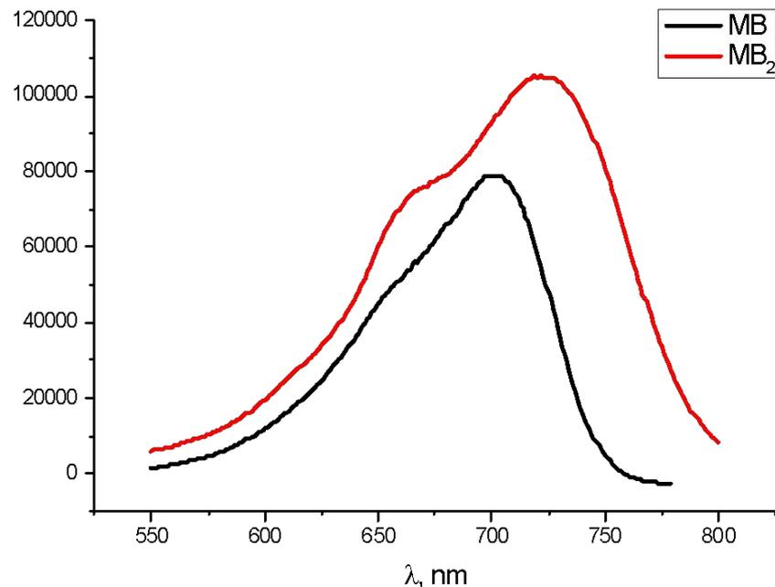
**Рис. 9.** Рассчитанные спектры поглощения комплексов спиропирана **1** с  $\text{Co}^{+2}$  различного состава
