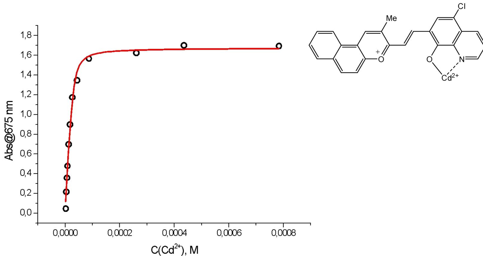
**Рис. 11.** Зависимость оптической плотности в максимуме длинноволнового поглощения комплекса спиробипирана **2** с Cd<sup>2+</sup>, точки – эксперимент, сплошная кривая – результат расчета.
