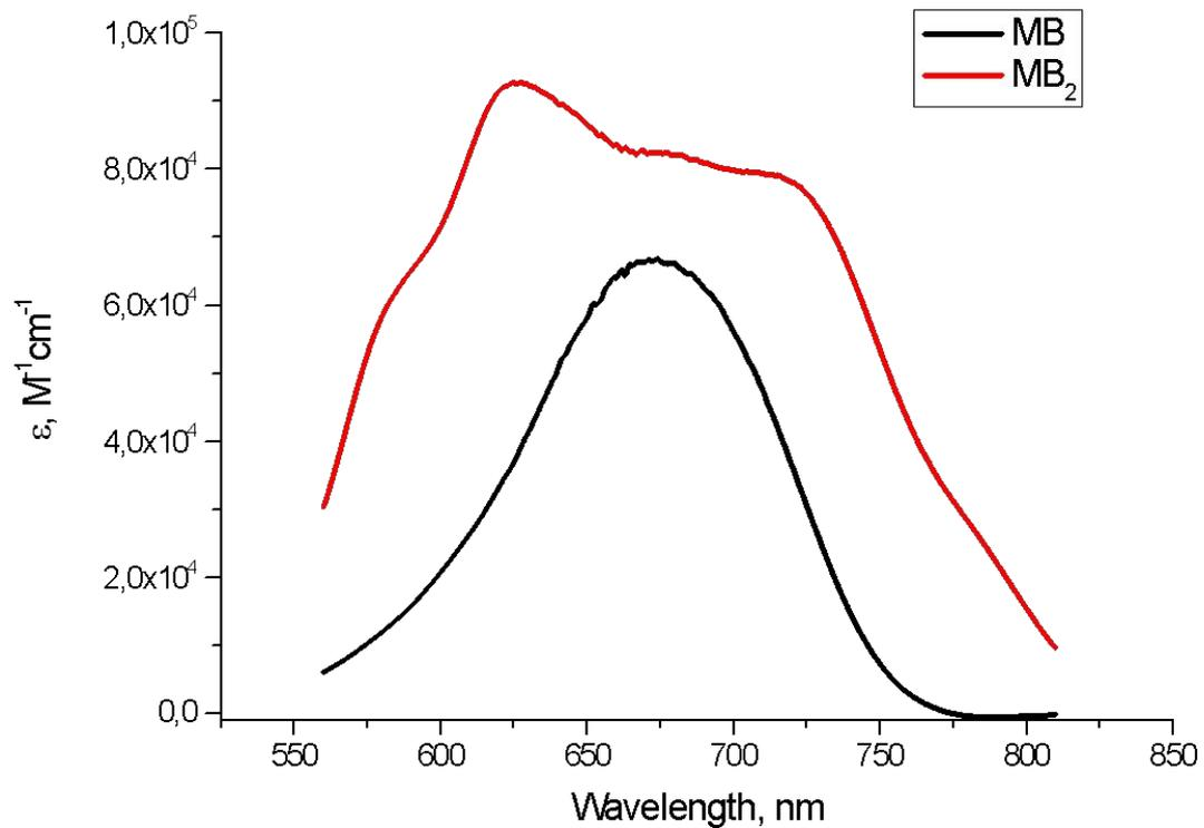
**Рис. 13. Рассчитанные спектры поглощения комплексов спиропирана **2** с Ni<sup>2+</sup> различного состава**
