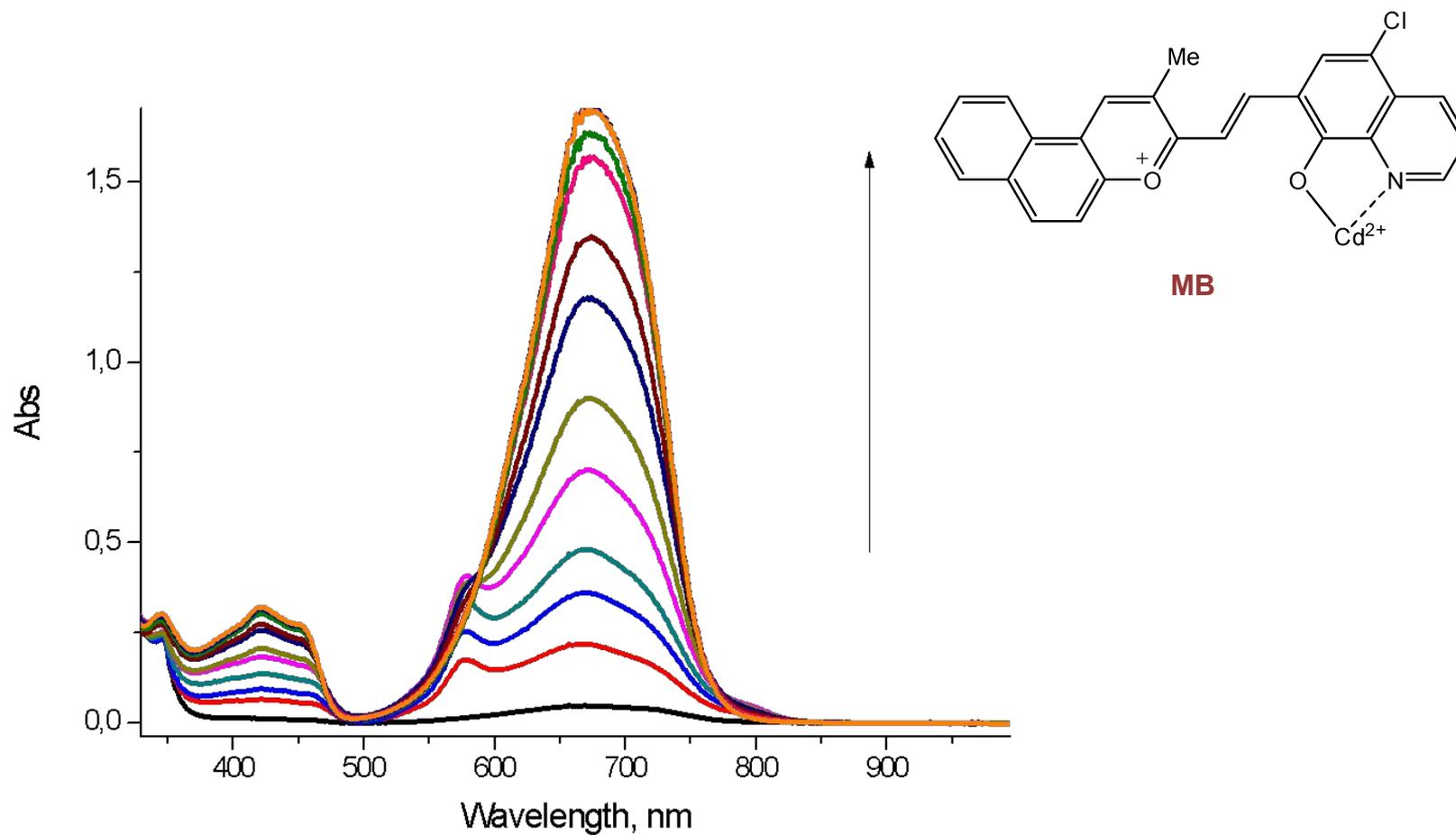
Рис. 10. Спектры поглощения спиробипирана **2** в ацетоне при добавлении различных количеств соли Cd<sup>2+</sup>.
