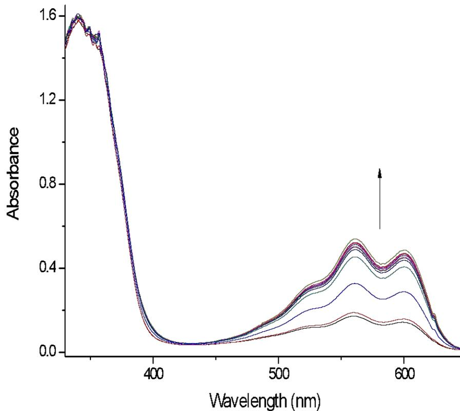
**Рисунок 4. Фотоокрашивание раствора спиропирана **3** при облучении УФ-светом,  $T = 293\text{ K}$ .**
