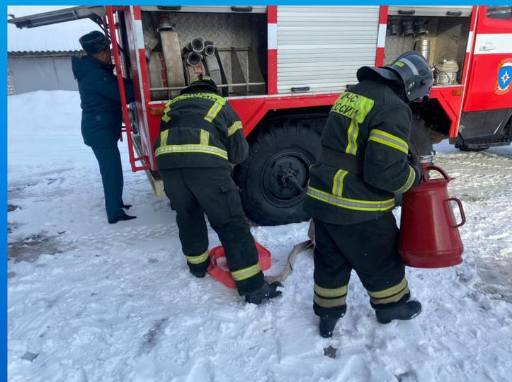
Водитель автомобиля (пожарного) заводит автомобиль, включает привод пожарного насоса, открывает насосный отсек и имитирует подачу огнетушащих веществ.
