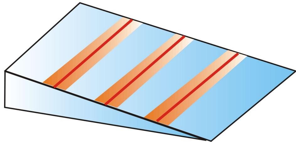
**Полосы равного наклона** получаются при освещении пластинки постоянной толщины рассеянным светом в котором содержатся лучи разных направлений.
