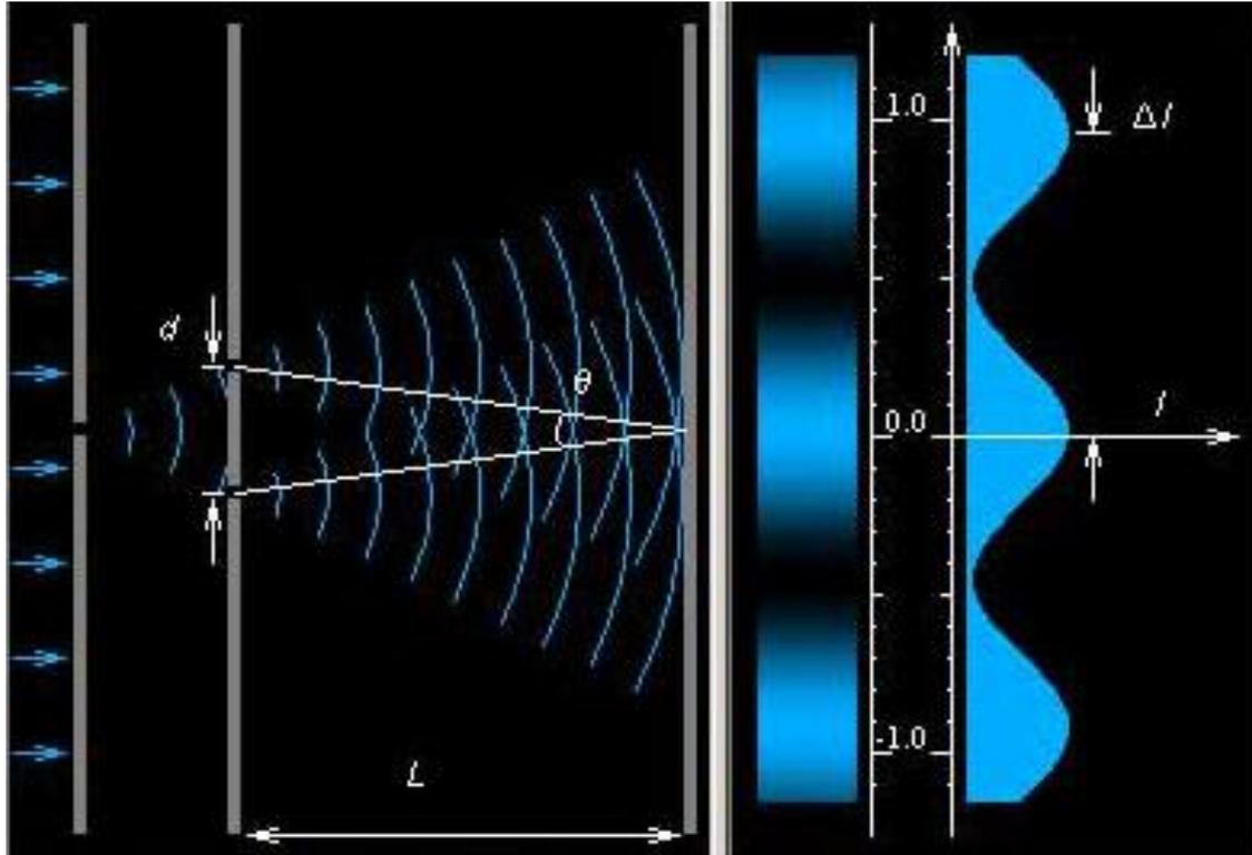
Параллельный пучок света падает на экран с небольшим отверстием. Пройдя через отверстие, свет доходит до второго экрана, в котором проделаны две щели. Когерентные пучки, излучаемые каждой из щелей, интерferируют на третьем экране.
