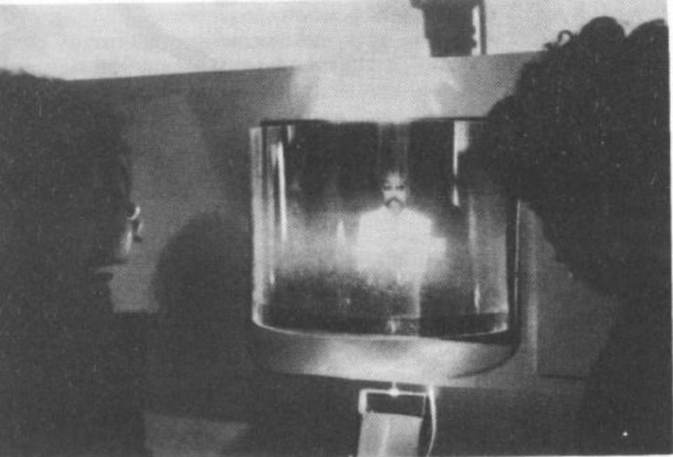
Голографический негатив, освещенный монохроматическим светом, дает полное трехмерное изображение, парящее в пространстве
