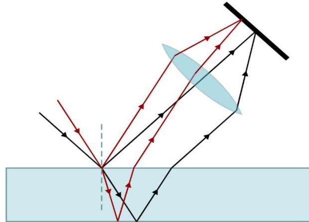
**Полосы равной толщины** наблюдаются при освещении пластинки переменной толщины (клина) параллельным пучком света.
