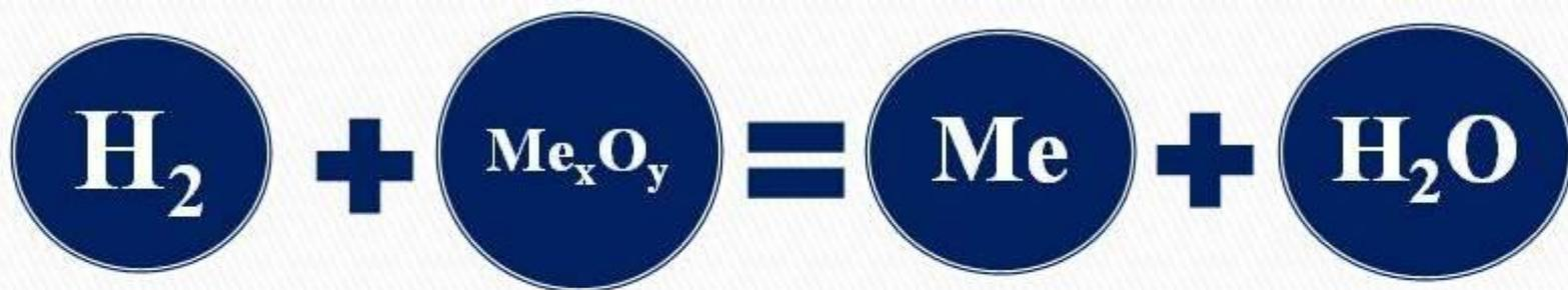
**Водород + Оксид металла = Металл + Вода**
