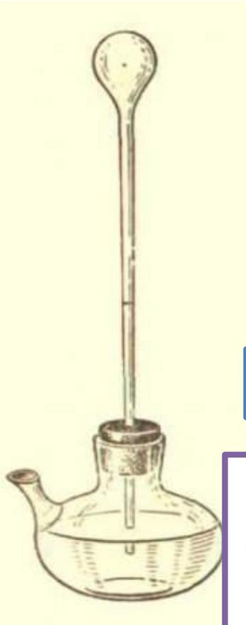
Первый прибор для объективной оценки температуры был изобретен Галилеем в 1597 г – термоскоп.
