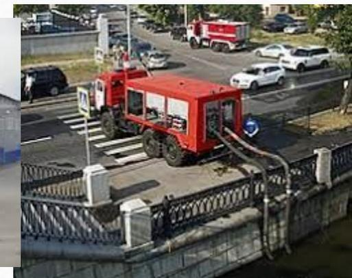
Специальные – предназначены для доставки к месту пожара личного состава, пожарно-технического инструмента и оборудования. Используются для выполнения специальных работ на пожаре.
