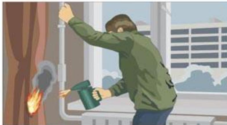
Отогревание замёрзших труб газовыми лампами и факелами
