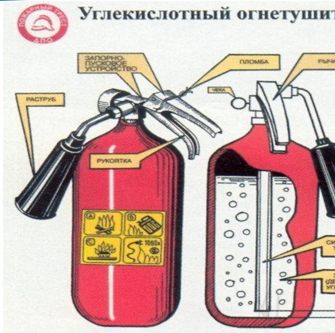
Предназначен для тушения горючих материалов классов А, В, С, Д, Е. В качестве огнетушащего вещества используется диоксид углерода, который находится в баллоне в жидкой фазе под давлением 60 атмосфер.
