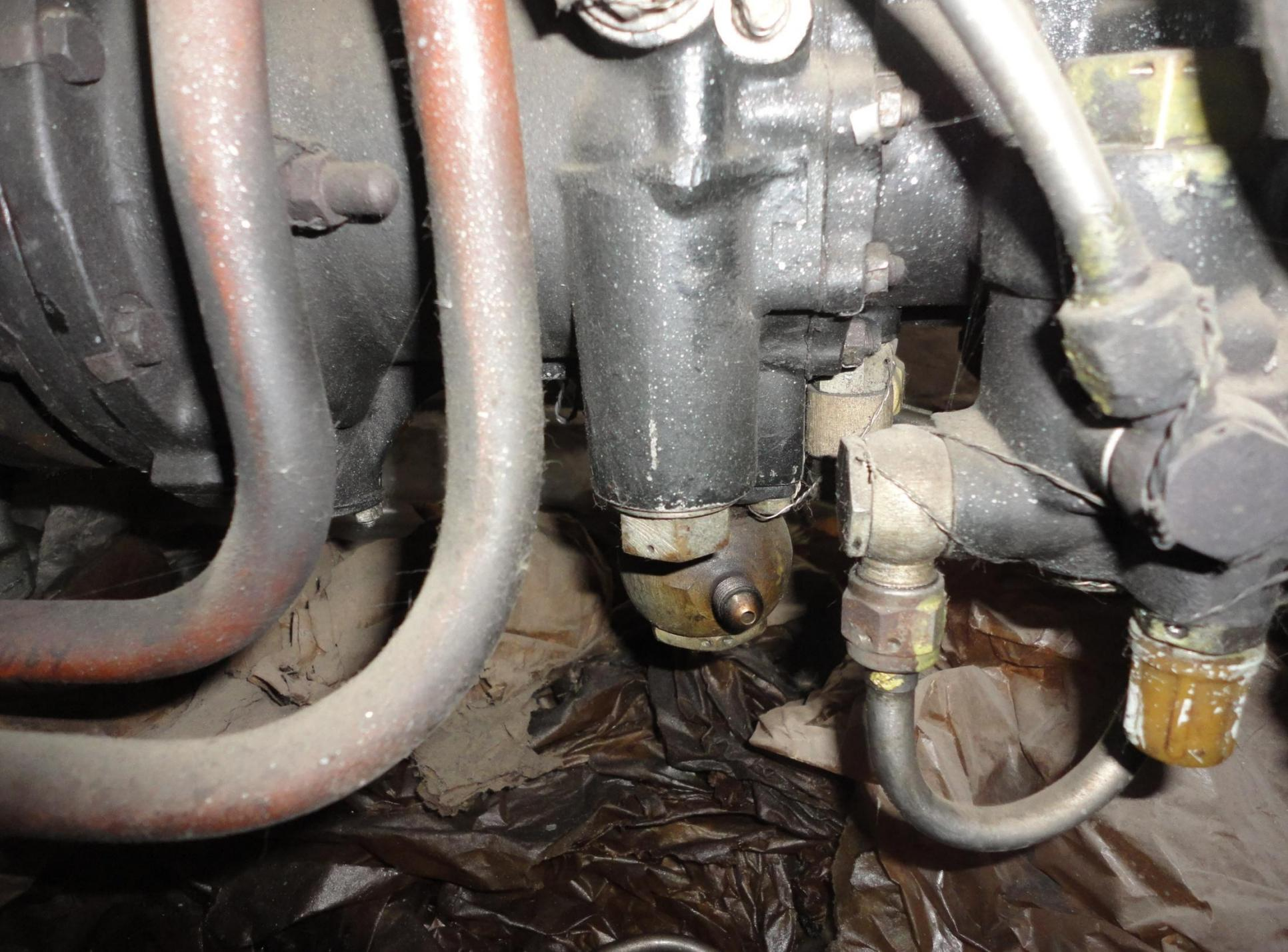
**Снятие и осмотр топливных фильтров
