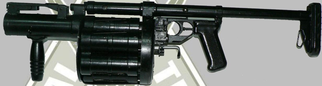
Вся конструкция собрана на корпусе в форме дисковидной коробки с трубчатой осью и трубчатой же штангой. На ось надета винтовая заводная пружина, работающая на кручение. Блок стволов включает шесть 40-мм «мортирок». Канал ствола "мортирки" аналогичен стволу ГП-25 и имеет 12 винтовых нарезов. Заряд вкладывается в ствол спереди и удерживается подпружиненным фиксатором.
