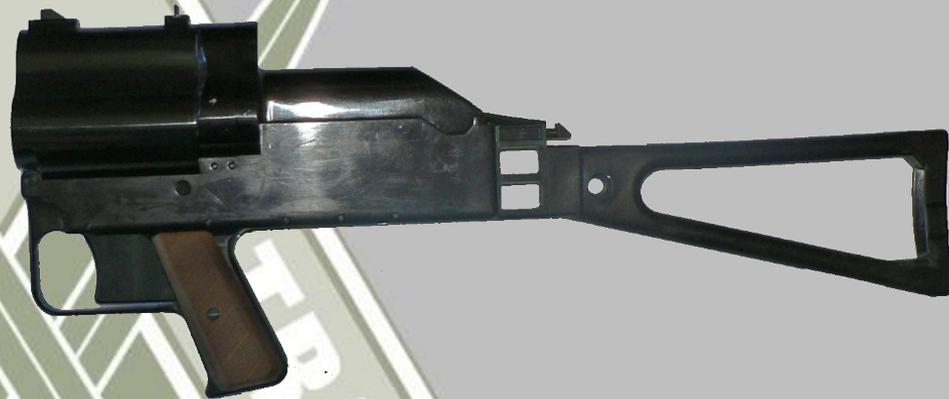
**Гранатомет представляет собой трехствольное оружие с откидывающимися гладкими стволами. Заряжание гранатомета производится с казенной части ствола. Небольшие габариты и масса гранатомета позволяют производить стрельбу из него одной рукой.**
