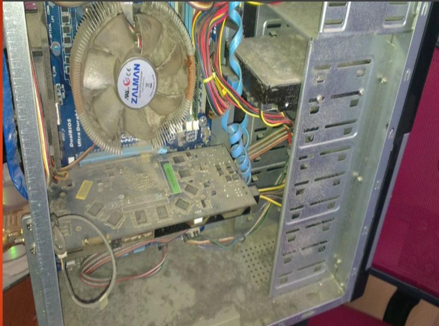
На данном этапе сколько бы мы не видели там пыли говорим следующие « так работать не возможно пыль попадет в какой либо слот при разборке и как следствие коротнет ( или же используем след момент: при перепаде температуры пыль впитывает влагу в следствие чего может произойти замыкание) , у вас дома есть пылесос ?» нам приносят пылесос начинаем чистку!
