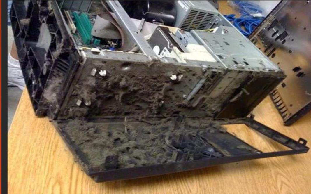
При данном Этапе чистки мы должны полностью все вытащить из коробки если это ПК так же как на картинке (разбирая корпус фронт панель тоже снимем ) чистим корпус разобрав его полностью вытаскивая и раскручивая все до болтика вытаскивая все комплектующие не ленимся!
