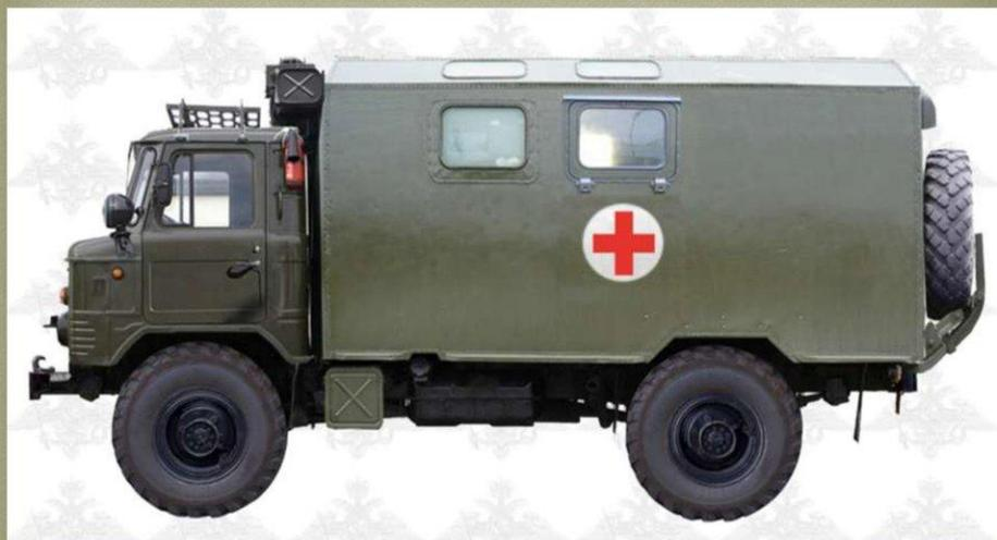
Санитарный автомобиль АС-66 на базе грузового автомобиля ГАЗ-66
