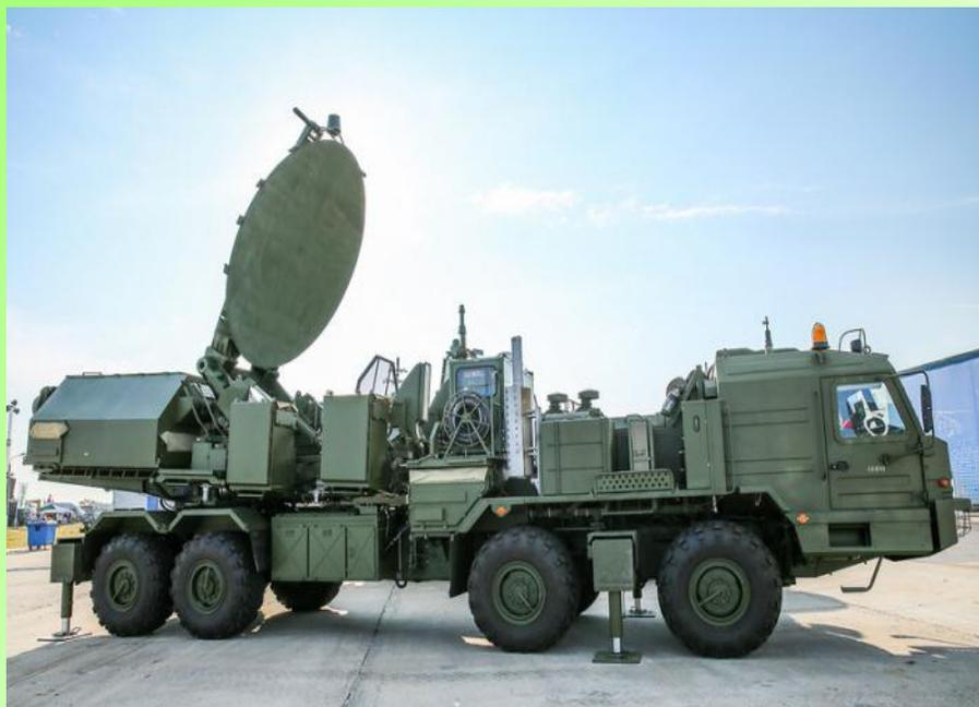
**Мобильный комплекс РЭБ «Красуха-4»** является активно-пассивной системой, сочетающей возможности переизлучения электромагнитных полей, создаваемых антеннами раннего оповещения (в том числе АВАКС), и создание активных направленных помех. Работа комплекса «сводит с ума» системы управления беспилотных летательных аппаратов и блоки наведения ракет вероятного противника.
