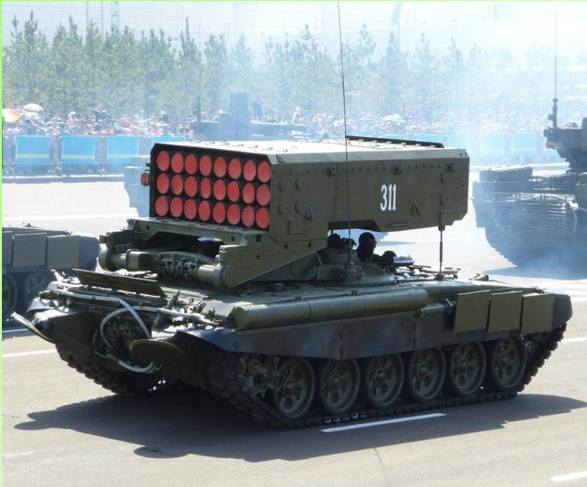
**ТОС-1 «Буратино» и ТОС-1А «Солнцепек»** могут вести огонь одиночными или двойными выстрелами. Длительность полного залпа при одиночных пусках составляет 12 секунд, при парных – 6 секунд. Время подготовки комплекса к стрельбе после остановки машины составляет 90 секунд. В качестве наполнителя боевой части термобарических боеприпасов применяется смесь из жидкости (пропилнитрат) и порошка легких металлов (магний)..
