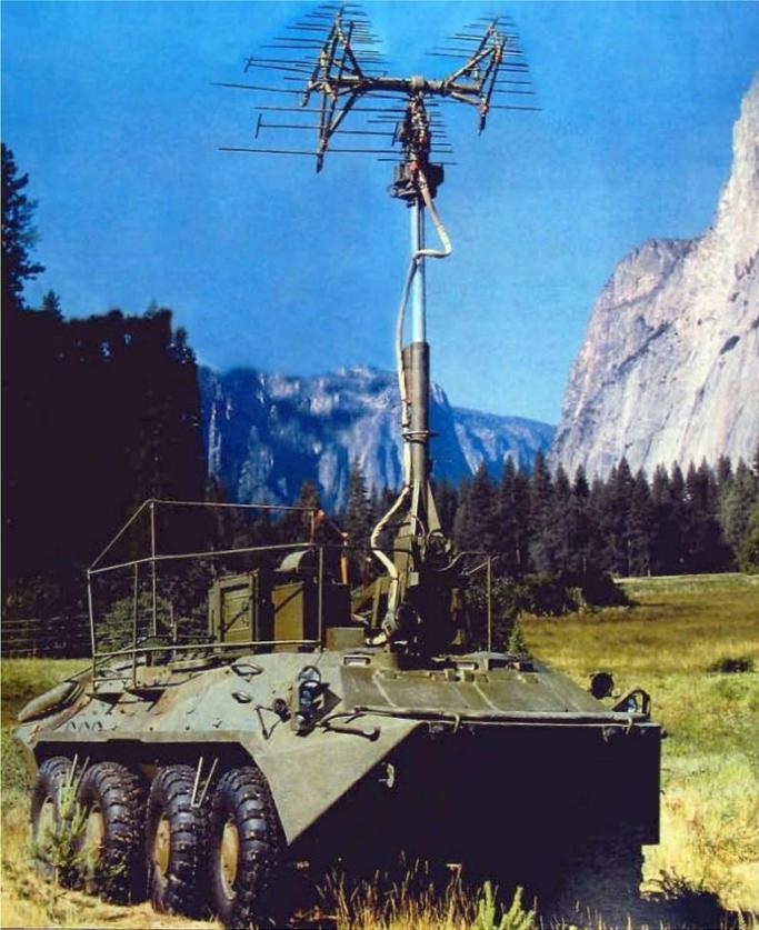
Машина «Ртуть-БМ» является средством радиоэлектронной борьбы и предназначена для снижения воздействия поражающих элементов артиллерийских снарядов на дружественные войска и бронетехнику путём влияния на режим работы радиовзрывателя. Его можно использовать для глушения частот, на которых противник ведет радиосвязь. Одна боевая машина способна обеспечить безопасность войск на территории 50 гектаров.
