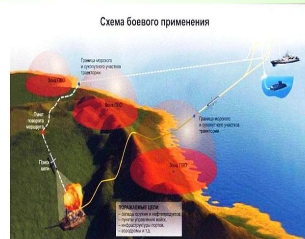
*Полет ракет проходит по заранее заложенному маршруту, в соответствии с данными разведки относительно положения цели и наличия средств противовоздушной обороны. Ракеты способны преодолевать зоны развитой системы ПВО противника, что обеспечивается предельно малыми высотами полета. Ракета ЗМ-14Э оснащена мощной 450-килограммовой фугасной боевой частью с опцией воздушного подрыва. Дальность пуска 2600 км. Экспортный вариант ограничен дальностью 300 км*
