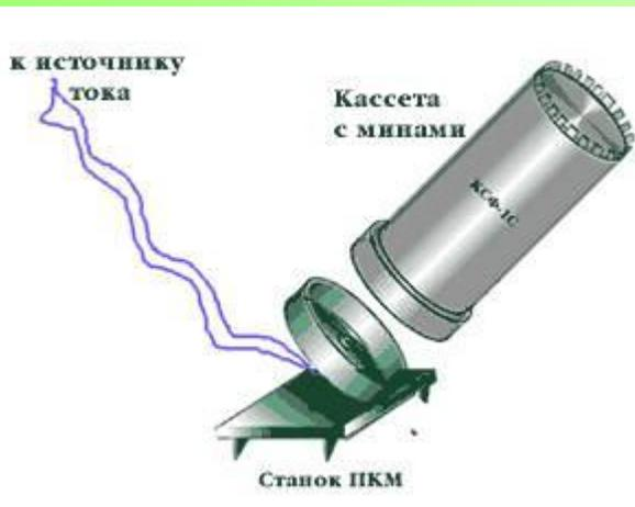
**Переносной комплект минирования «Ветер-М»**, Особенность комплекта состоит в том, что его можно устанавливать не только заблаговременно, но и непосредственно в ходе боя. В комплект входит примитивный пусковой станок подрывной машины ПМ-4, две катушки кабеля по 50 метров в каждой и сумка для переноски. Весит весь комплект около 2,5 килограммов.
