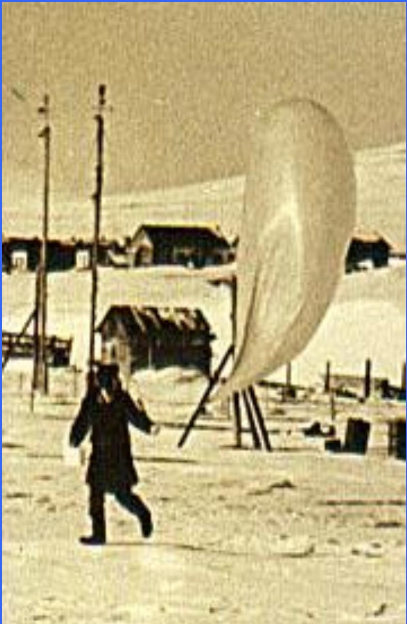
Сведения о верхних слоях атмосферы получают с помощью шар-радиозонда, причем у поверхности Земли при запуске его оболочка заполняется не полностью.
