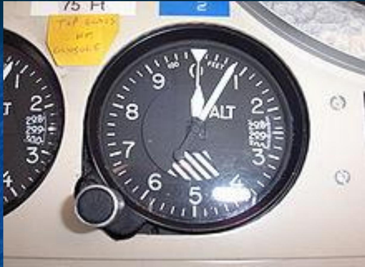
Высотомер- прибор для измерения
