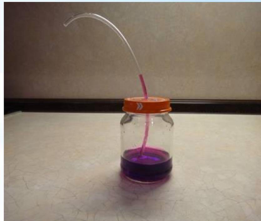
Для конструирования аналога барометра возьмём стеклянную баночку с герметичной крышкой. В банку нальём воду подкрашенную марганцовкой. Плотнo закроем крышку банки. Вдуваем немного воздуха в выступающий конец трубки. Он вытеснит жидкость в трубку и создаст индикаторный столб.
