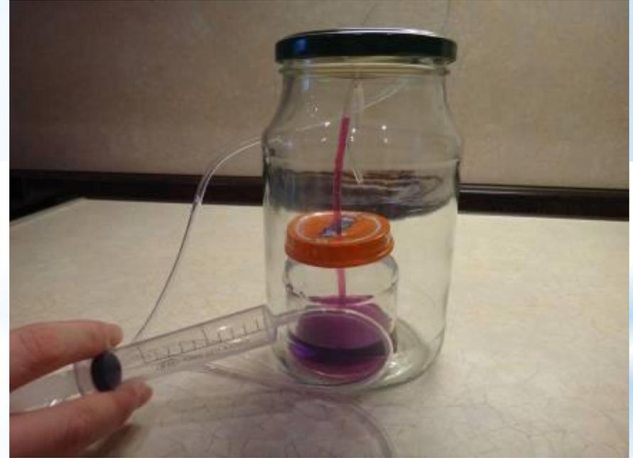
Демонстрируем принцип работы нашего аналога барометра. Помещаем его в большую банку и плотно её закрываем. Начинаем шприцом закачивать воздух в банку, имитируя повышение атмосферного давления. При этом уровень жидкости в трубке барометра понижается. Затем начинаем откачивать воздух, имитируя понижение атмосферного давления. При этом уровень жидкости в трубке барометра повышается.
