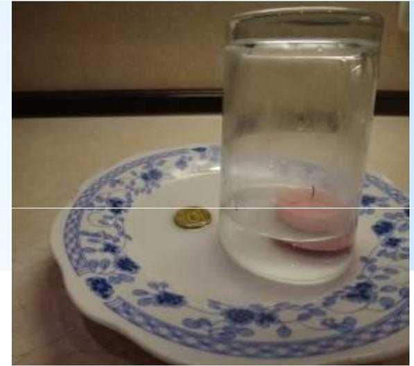
Когда горящая свечка нагрела в стакане воздух, давление его возросло, часть воздуха вышла наружу. Потом свеча погасла, воздух остыл, и при охлаждении его давление уменьшилось, под стакан вошла вода, вгоняемая туда атмосферным давлением.
