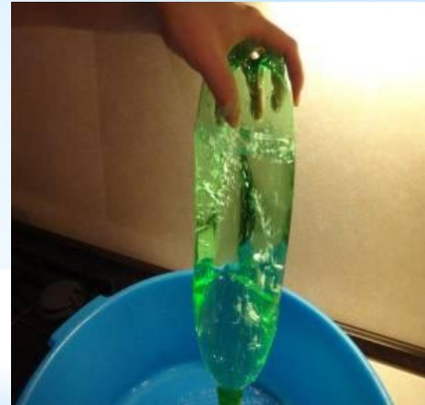
**Это происходит потому, что при вылипании воды в бутылке образуется разреженное пространство и под действием давления наружного воздуха стенки бутылки сжимаются.**
