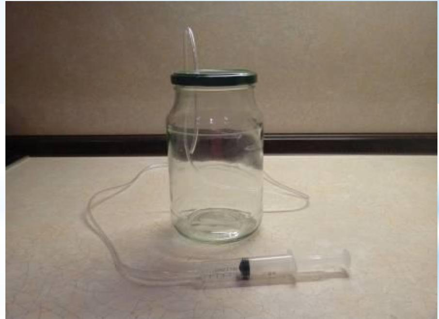
**Для имитации изменения атмосферного давления сделаем следующее устройство. Это устройство работает следующим образом: для увеличения давления в банке нам нужно шприцом накачивать воздух в банку, а для уменьшения – наоборот откачивать. Таким образом, мы можем имитировать изменения атмосферного давления.**
