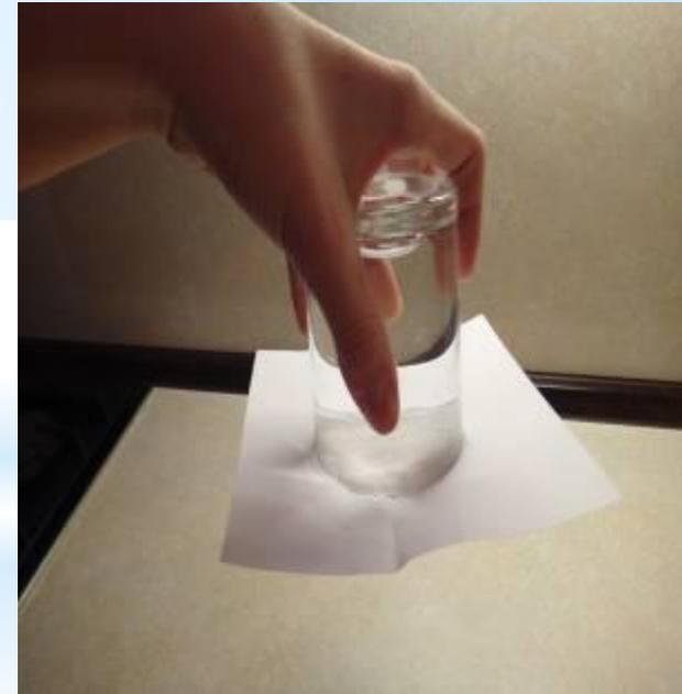
**Это происходит потому, что после переворачивания стакана между дном и водой образуется разреженное пространство, поэтому вода удерживается в стакане силой атмосферного давления, которое давит снизу.**
