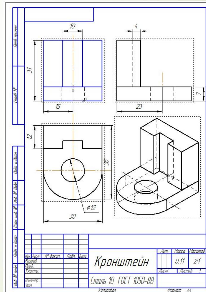
Построить три стандартных вида и изометрическую проекцию детали **Кронштейн**.
