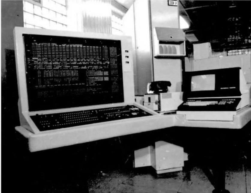
Симметричный многопроцессорный (10 процессоров) вычислительный комплекс "Эльбрус-2" на матричных ECL БИС, выпущен в 1985 г. (В.С. Бурцев).
