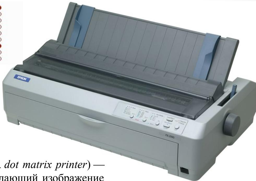
**Матричный принтер** (англ. *dot matrix printer*) — компьютерный принтер, создающий изображение на бумаге из отдельных маленьких точек ударным способом
