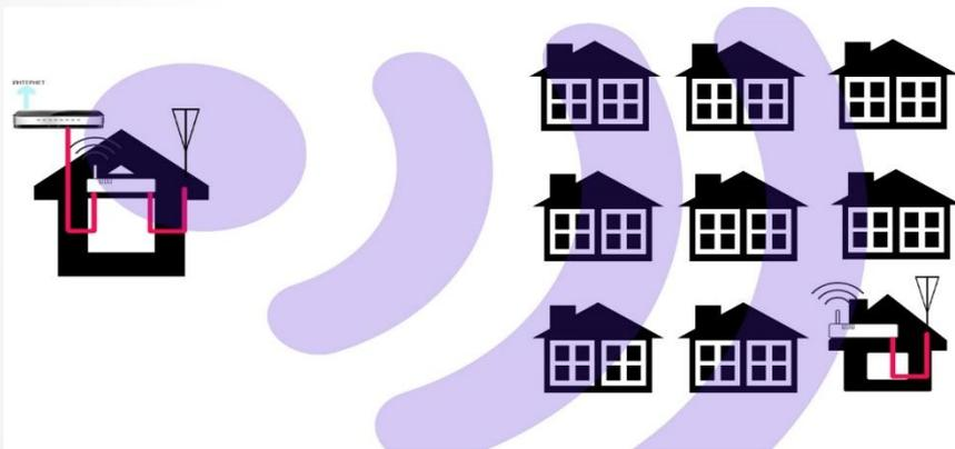
Устройства с направленными антеннами и мощными передатчиками позволяют организовать соединение точка-точка на расстоянии более 1 км
