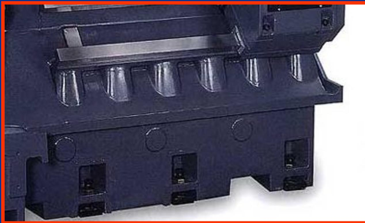
**Направляющие станков с ЧПУ** имеют высокую износостойкость и малую силу трения, что позволяет снизить мощность следящего привода, увеличить точность перемещений, уменьшить рассогласование в следящей системе.
