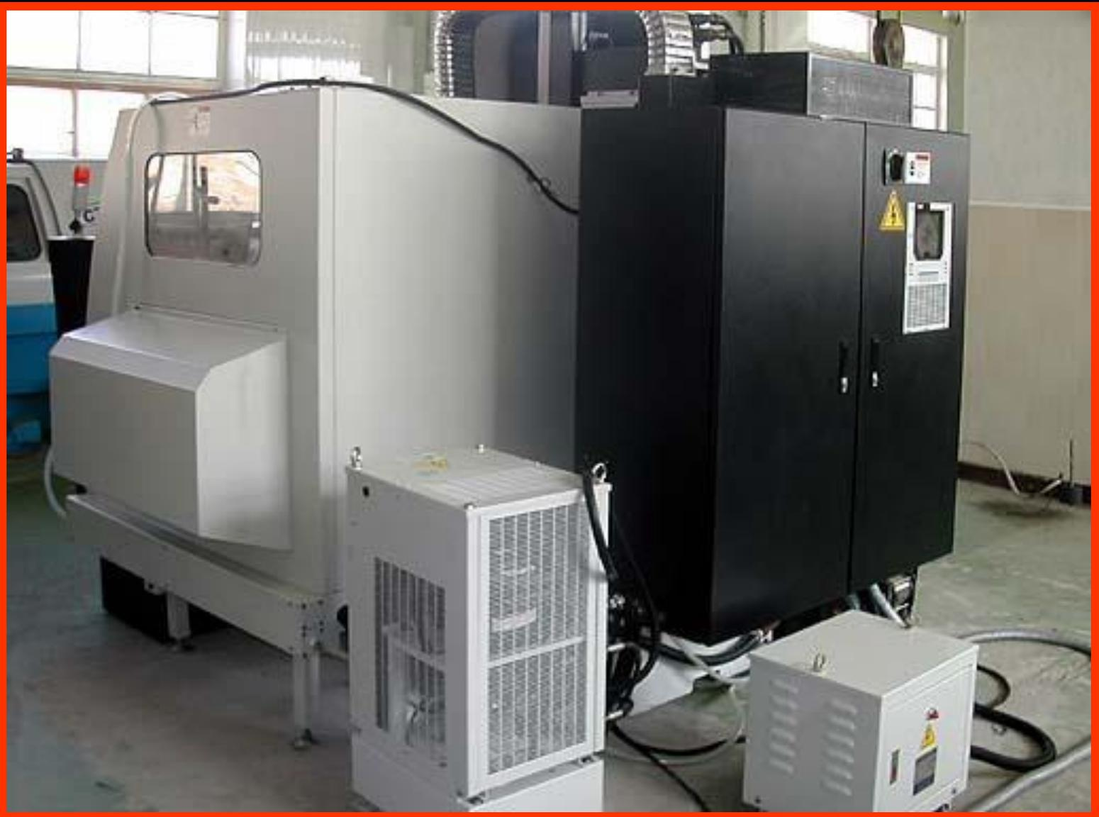
**компрессорная система охлаждения шпинделя токарного станка с ЧПУ
