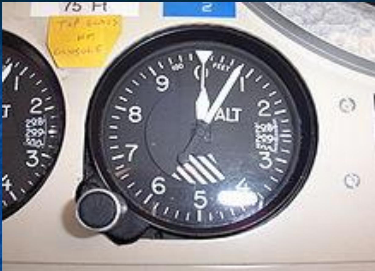
Высотомер- прибор для измерения
