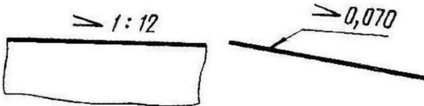
На строительных чертежах уклон указывают в виде простой дроби
