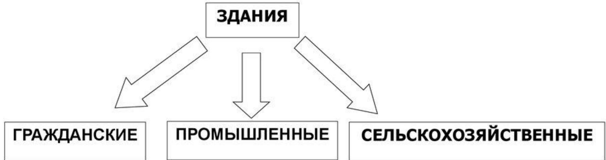
**Промышленные здания** служат для размещения орудий производства и выполнения трудовых процессов. Они предназначены для обслуживания нужд промышленности и транспорта.
