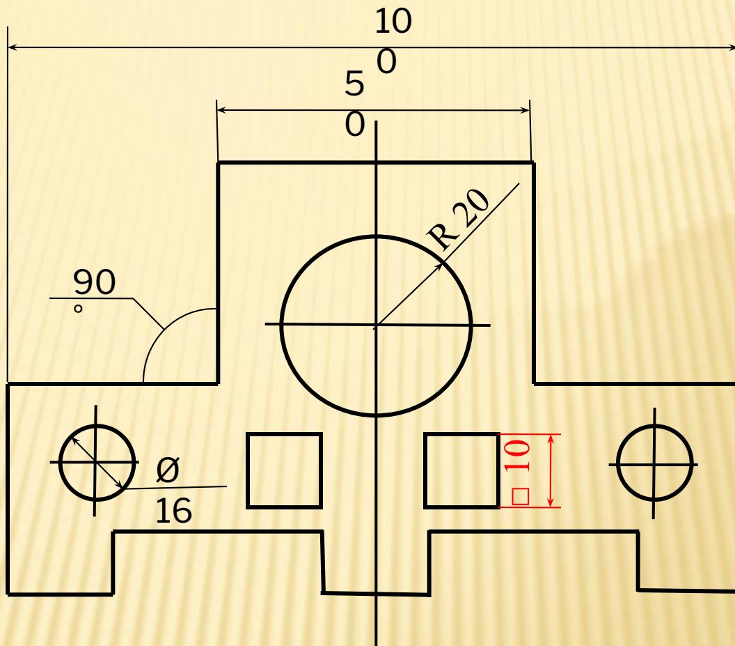
Перед размерным числом, указывающим сторону квадратного элемента, наносят □.
