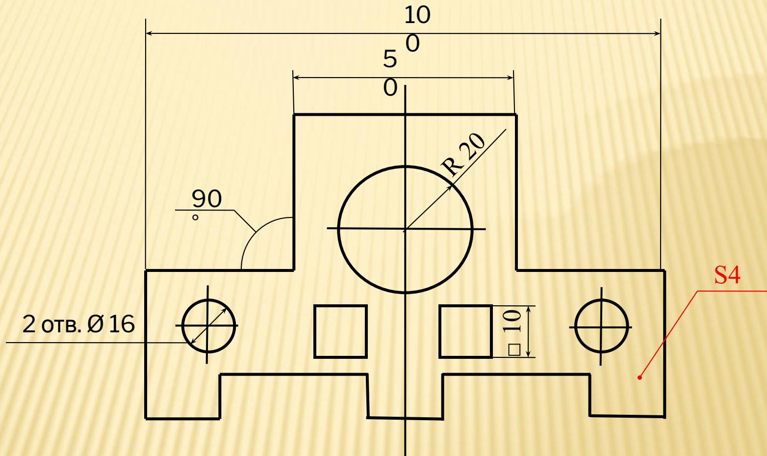
При изображении плоских деталей в одной проекции, толщина детали указывается S.
