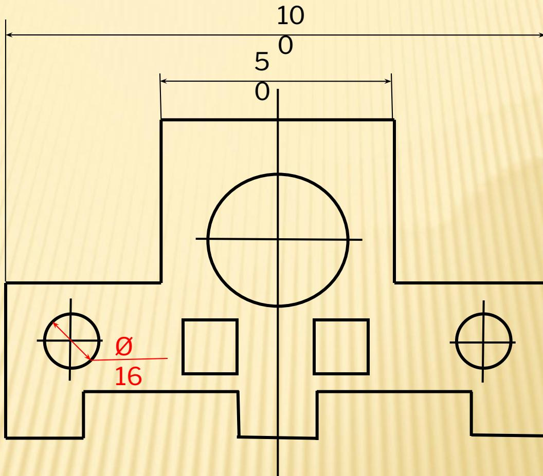
Для обозначения диаметра перед размерным числом наносят специальный знак  $\varnothing$ .
