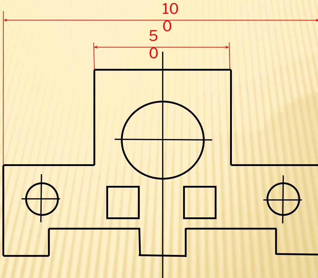
Если на чертеже несколько размерных линий, параллельных друг другу, то ближе к изображению наносят меньший размер.
