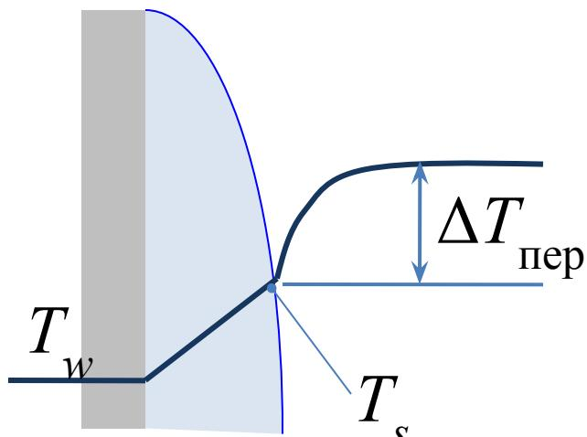
Если температура пара выше температуры насыщения, то к поверхности жидкости из пара подводится тепло:
