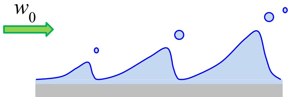
Вследствие касательных напряжений межфазная поверхность становится неустойчивой. На гребнях волн возможен унос жидкости в виде капель.
