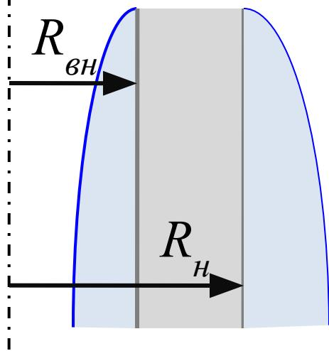
Если толщина пленки жидкости мала по сравнению с радиусом трубы, то можно пользоваться формулами для вертикальной плоскости!
