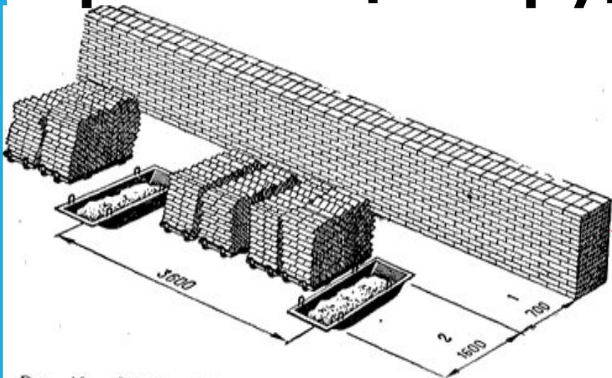
Рис. 10. Схема размещения материалов на рабочем месте при кладке глухих стен
