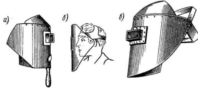
Индивидуальные защитные средства сварщика. Для защиты тела от ожогов сварщик пользуется брезентовым костюмом, брезентовыми рукавицами и кожаной или валяной обувью. Брюки должны быть гладкими, без отворотов с напуском поверх ботинок или валенок. Рукавицы должны иметь напуск на рукава и завязываться тесьмой. Прямая одежда и отсутствие открытых частей тела исключают возможность попадания брызг металла на тело и в складки спецодежды.
