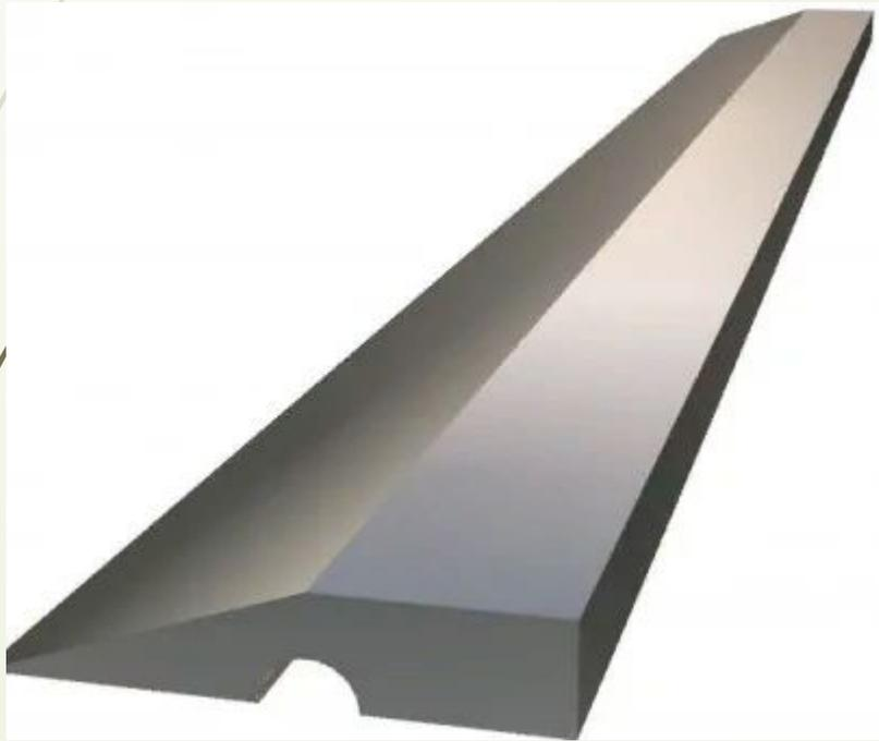
Этот строительный инструмент — длинная металлическая или деревянная рейка. Главное ее отличие от «родственниц» — идеальная ровность. Цель правила — выявление даже малейших дефектов, определение крохотных впадин, выпуклостей либо иных неровностей. Инструмент прикладывают к ряду, затем проверяют его прилегание к кладке по всей длине.
