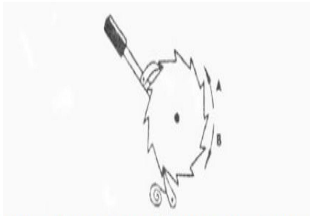
4. В каком направлении будет двигаться зубчатое колесо, если ручку слева двигать вниз и вверх в направлении пунктирных стрелок?
