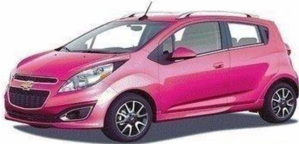
Особо малый класс, супермини, городской автомобиль — самые маленькие автомобили, предназначенные для условий тесного города. Динамические и ходовые качества зачастую посредственные. Тип кузова 3-дверный или 5-дверный хэтчбек. Длина автомобиля до 3,6 метров и ширина до 1,5 метра. Такие модели привлекательны своей экономичностью и возможностями парковки в ограниченном пространстве города.
