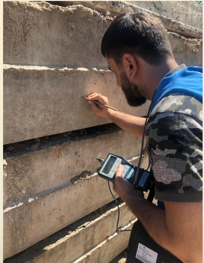
Фото 3. Определение прочности бетона неразрушающим методом контроля сотрудниками кафедры СКОиФ ВГТУ.
