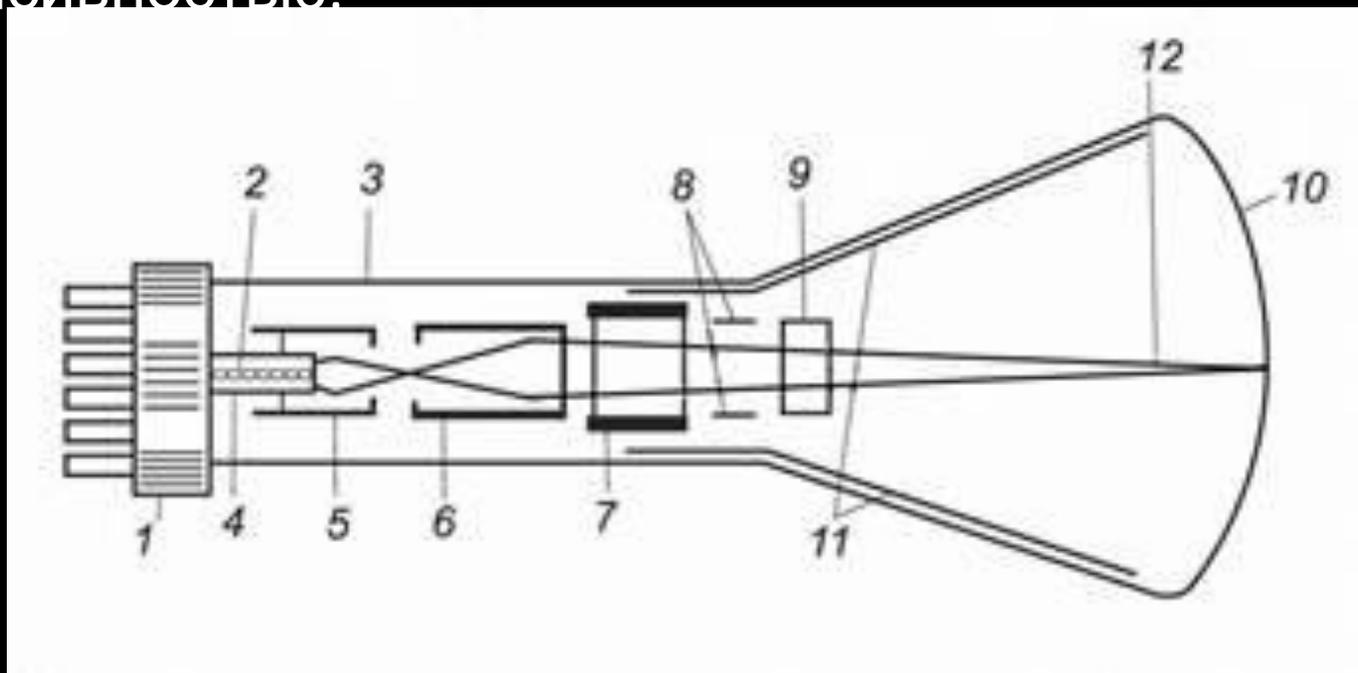
Далее следуют две пары отклоняющих пластин (8) и (9) (горизонтальные и вертикальные) которые могут менять направление луча и, наконец, экран (10) – дно колбы, покрытый люминесцирующим составом, благодаря которому становится видимым след электронного луча.
