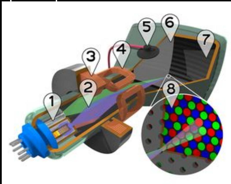
Кинескопы используются в системах растрового формирования изображения: различного рода телевизорах, мониторах, видеосистемах. Также в качестве устройства отображения на радиолокационных станциях, в устройствах специального назначения. В советские годы использовались и в качестве наглядных пособий при изучении устройства электронно-лучевых приборов в целом.
