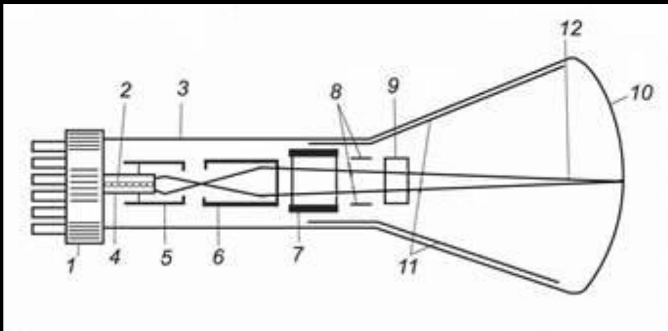
В состав катода входит вольфрамовая нить – нагреватель (2), расположенная в узкой трубке, торец которой (для уменьшения работы выхода электронов) покрыт слоем окиси бария или стронция и собственно является источником потока электронов. Процесс формирования электронов в узкий луч с помощью электростатических полей во многом напоминает действие оптических линз на световой луч. Поэтому система электродов (5,6,7) носит название электронно-оптич
