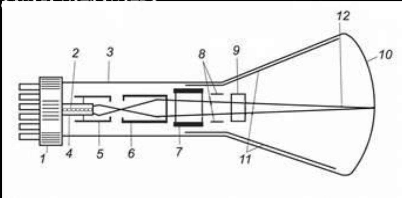
Электронный луч попадает в экран , покрытый люминофором . От бомбардировки электронами люминофор светится и быстро перемещающееся пятно переменной яркости создаёт на экране изображение.
