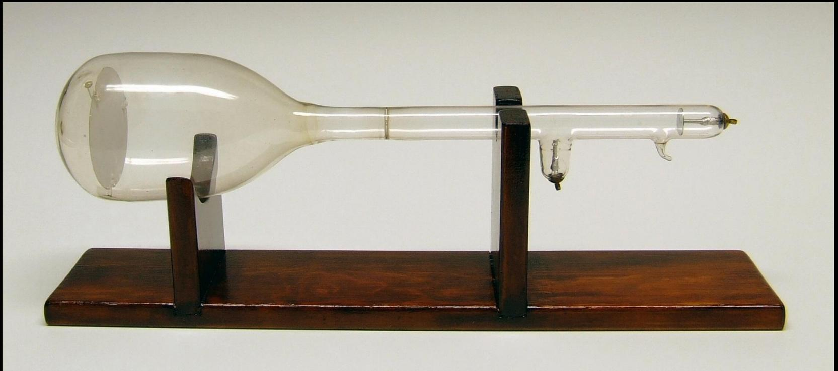
Луч отклонялся магнитно только в одном измерении, второе направление развёртывалось при помощи вращающегося зеркала. Браун решил не патентовать свое изобретение, выступал со множеством публичных демонстраций и публикаций в научной печати. Трубка Брауна использовалась и совершенствовалась многими учёными.
