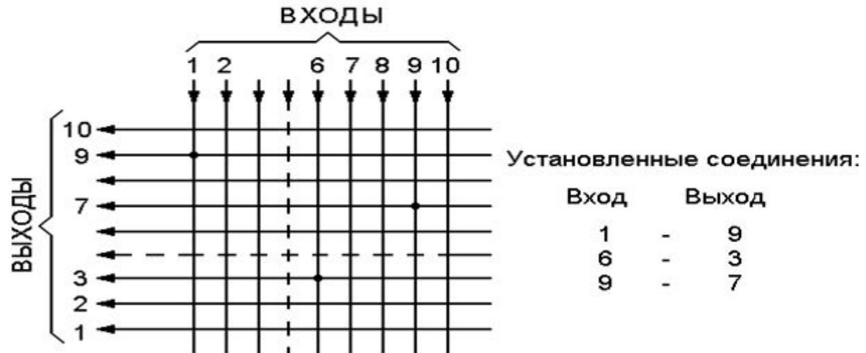
Рис. 5.5. Принцип установления соединения многokратным координатным соединителем
