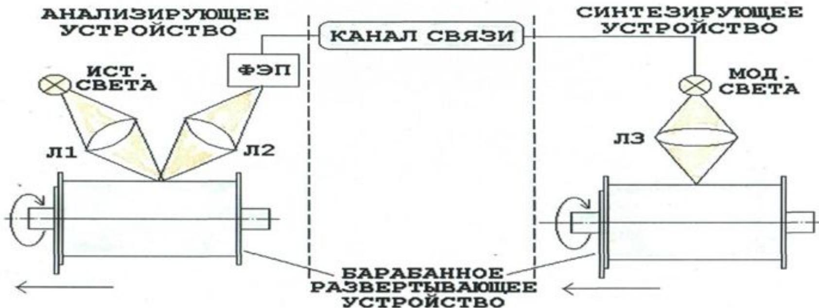
Рис. 6.10. Схема факсимильный аппарата барабанного типа
