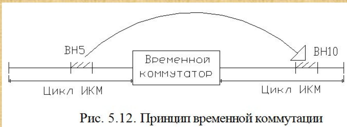
Рис. 5.12. Принцип временной коммутации
