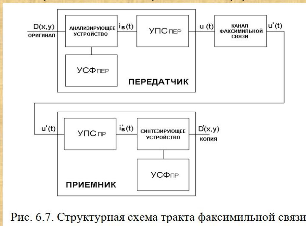
Рис. 6.7. Структурная схема тракта факсимильной связи
