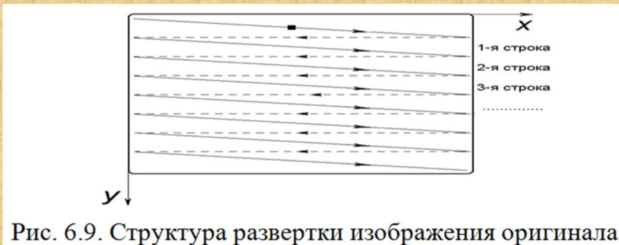
Рис. 6.9. Структура развертки изображения оригинала
