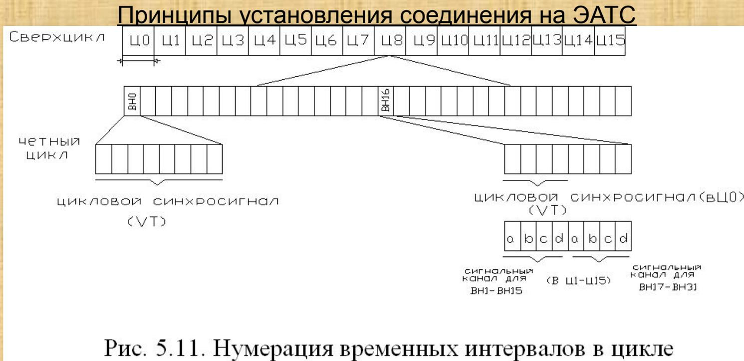
Рис. 5.11. Нумерация временных интервалов в цикле
