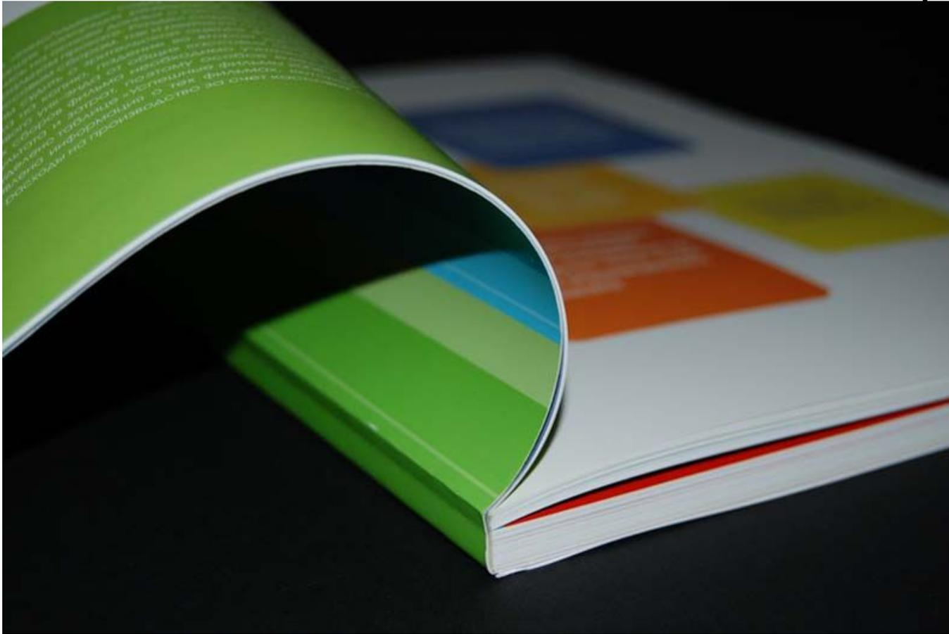
В процессе изготовления книг в мягком переплете страницы внутри блока компонуются либо тетрадками, либо составлением в подбор. Результатом первого варианта является издание с ниткошвейным внутренним блоком. Во втором случае получается книга с внутренним блоком на клеевом бесшвейном соединении (КБС).
