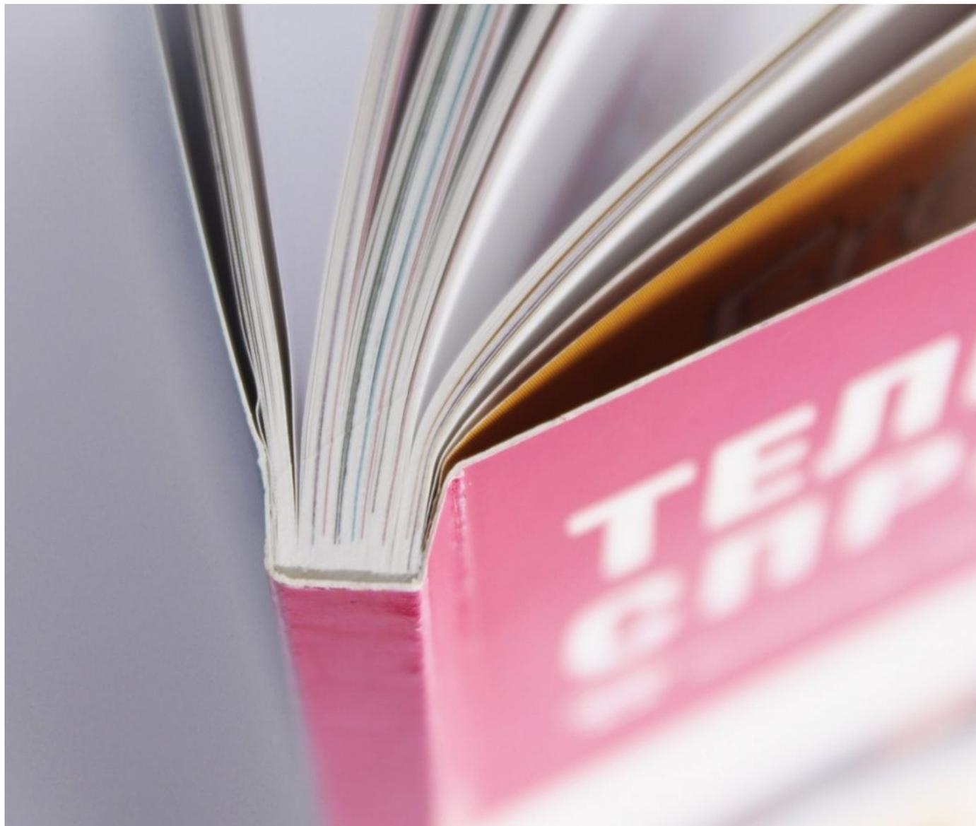
При таком виде переплета обложка приклеивается к книжному блоку. Чтобы клеевое соединение было более крепким, применяется торшенирование – на корешке блока создаются поперечные надрезы, которые в процессе соединения заполняются клеящим составом.
