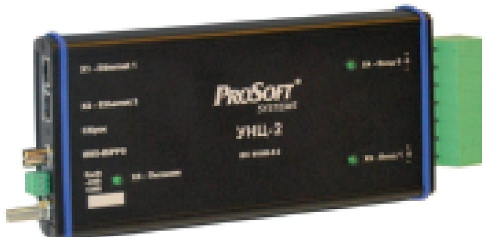
Устройство нормализации цифровое (УНЦ-2) предназначено для дискретизации аналогового сигнала и передачи полученных данных согласно стандарту IEC 61850-9-2 и IEC 61850-9-2LE.
