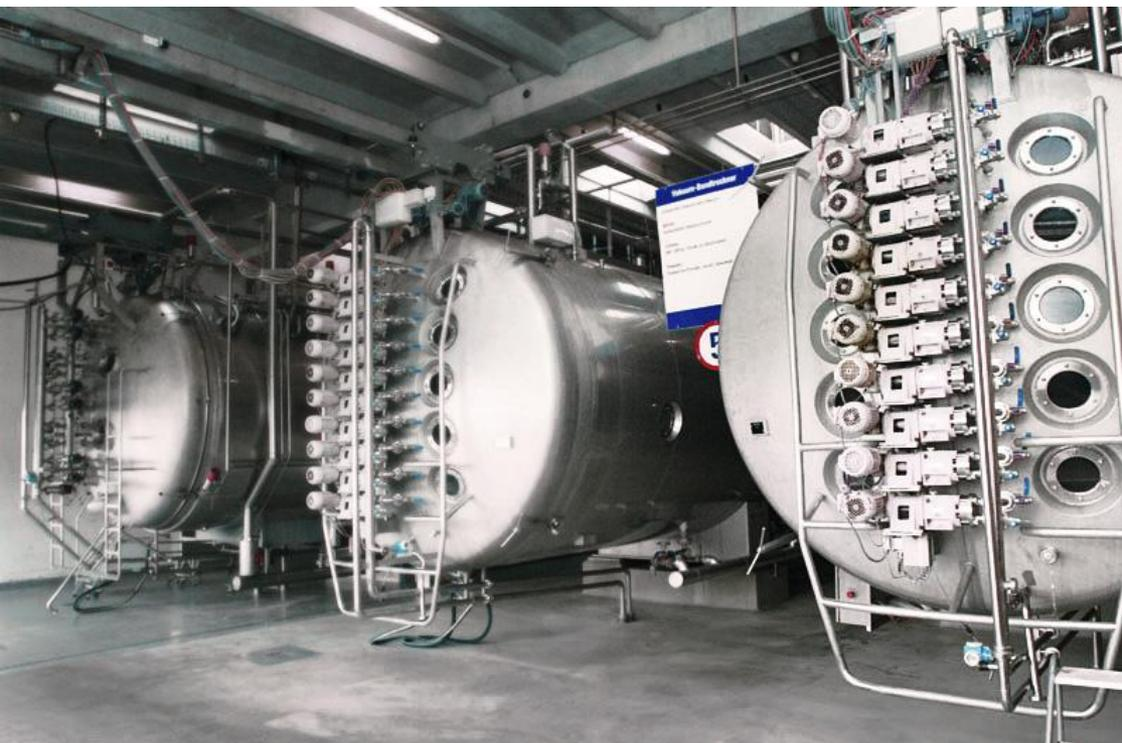
В так называемом вакууматоре густого сока Ovaltine сушат при низких температурах 45-50 °.
