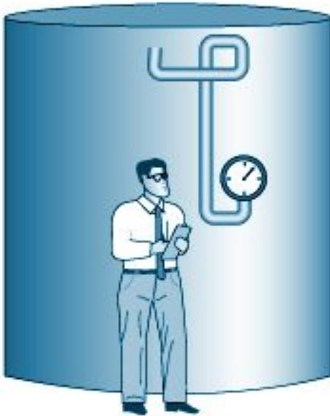
На этом рисунке показано правильное решение. На этапе проектирования оборудования учитывались требования к техническому обслуживанию и эксплуатации. Поэтому прибор был установлен таким образом, что его показания можно считывать на уровне пола. Опасность падения устраняется.
