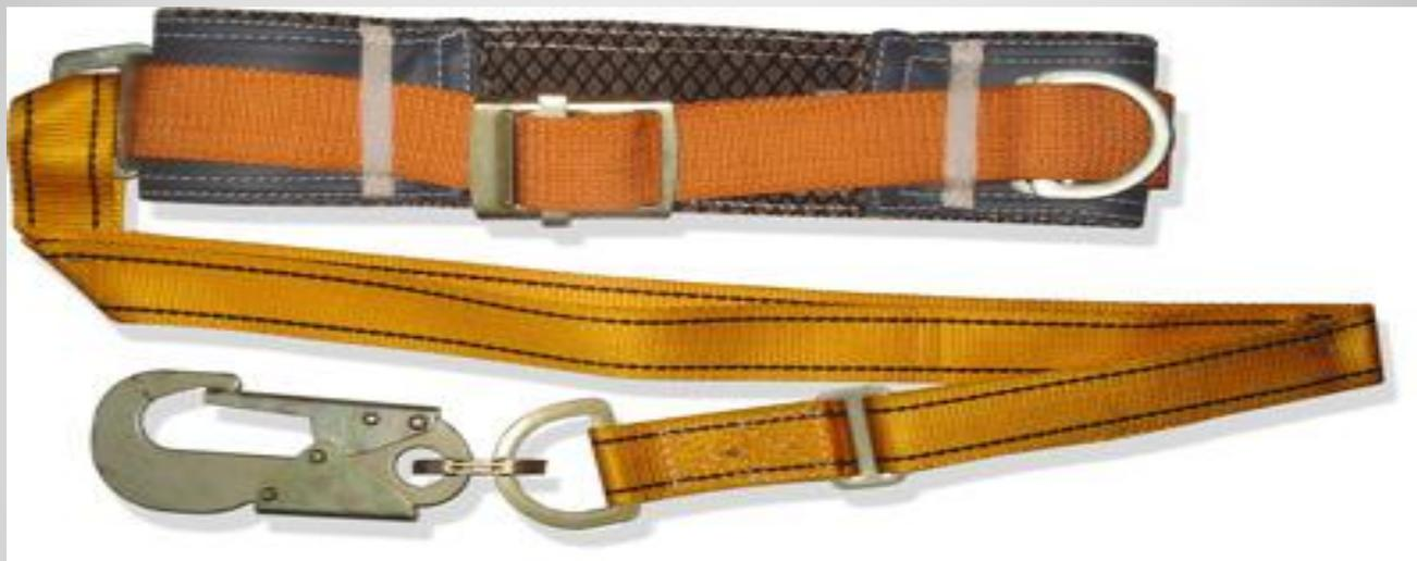
**Пояс предохранительный безлямочный** - разрешается применять только для фиксации работающего на рабочем месте в условиях, исключающих падение работающего, а также при подъёме (на мачтах, опорах воздушных линий электропередач и т. п.) к рабочему месту и спуске с него. Закрепление пояса стропом за элементы конструкций должно осуществляться таким образом, чтобы свободное падение в экстренном случае не превышало 0,5 метра.
