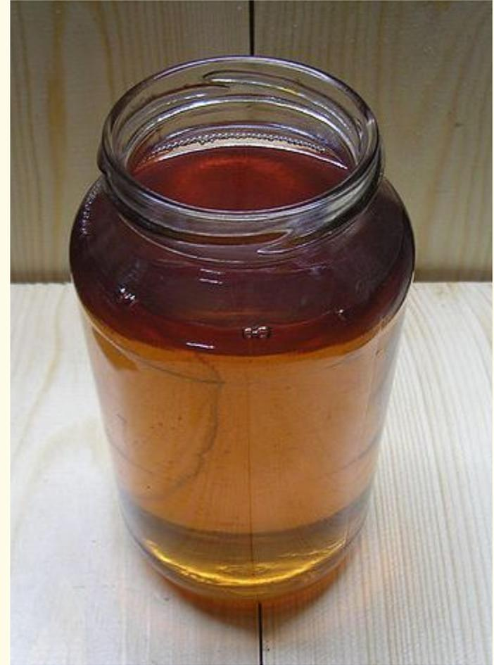
**Прокачиваемость** дизельного топлива характеризует процесс подачи его по трубопроводам и приборам системы питания двигателя. Зависит от температур помутнения и застывания, вязкости, наличия в топливе воды, механических примесей и смол.
