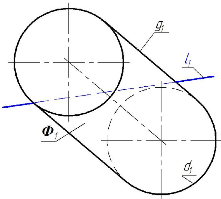
Задан наклонный эллиптический цилиндр  $\Phi$ .
