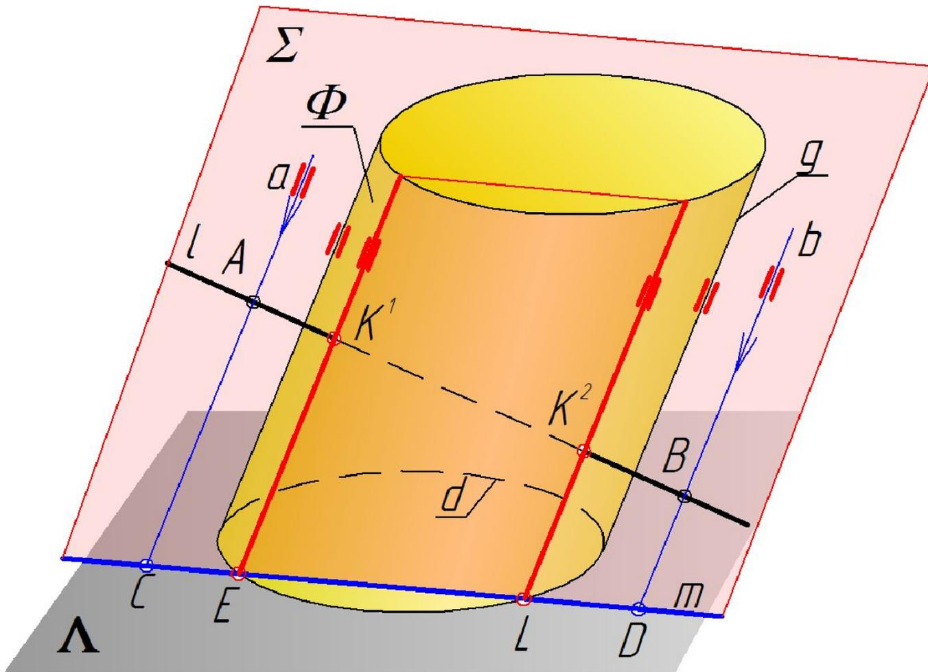
У цилиндрической поверхности есть два вида простых сечений плоскостью – две прямые (образующие) и окружность. Из двух перечисленных сечений в данном примере при заключении прямой в плоскость можно получить только сечение в виде двух прямых при условии, что секущая плоскость пройдет параллельно образующим цилиндрической поверхности.
