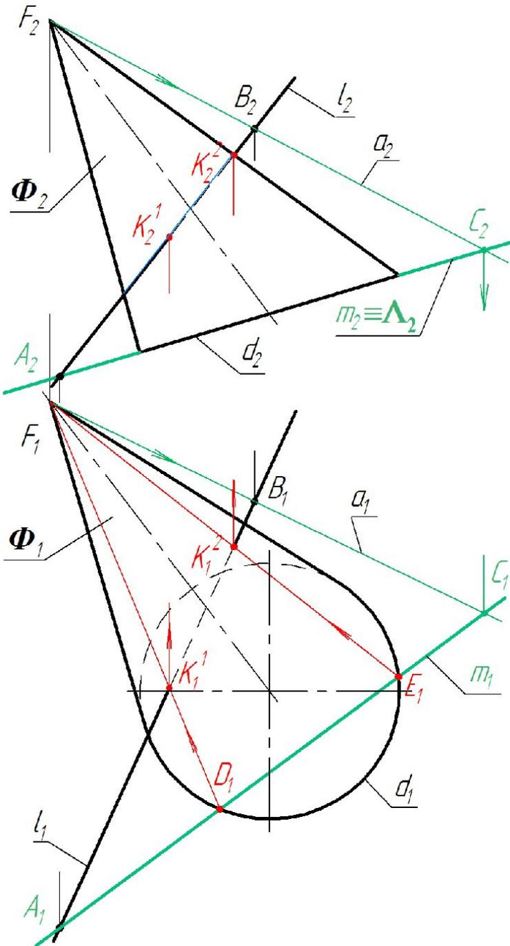
Вспомогательная секущая плоскость  $\Sigma$  будет плоскостью общего положения и задана точкой  $F$  и самой прямой  $l$ . Однако, такой вариант задания плоскости неудобен. Поэтому зададим плоскость  $\Sigma$  двумя пересекающимися прямыми: прямой  $l$  и прямой  $a(F, B)$ . Точка  $B$  – произвольная точка, принадлежащая прямой  $l$ .
