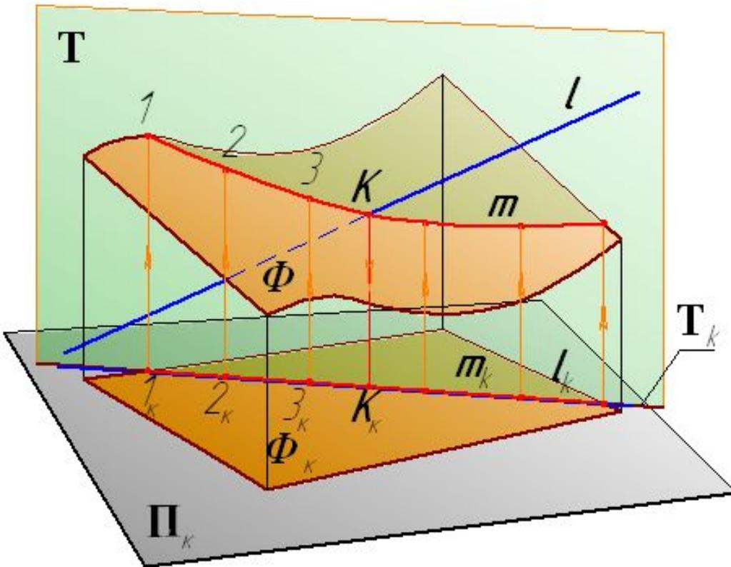
Линию  $m$ , принадлежащую поверхности  $\Phi$ , следует рассматривать как линию пересечения самой поверхности  $\Phi$  с какой-то плоскостью, например,  $T$ , в которую заключена прямая  $l$ .
