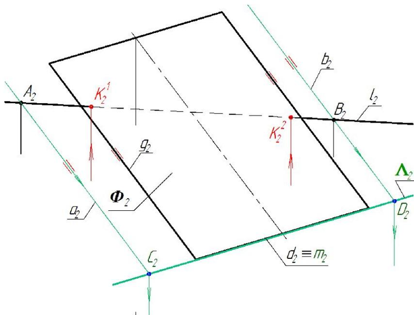
Вспомогательная секущая плоскость  $\Sigma$  будет плоскостью общего положения и задана двумя параллельными прямыми  $a$  и  $b$ , которые параллельны образующим цилиндрической поверхности и пересекают прямую  $l$  в произвольных точках  $A$  и  $B$ .
