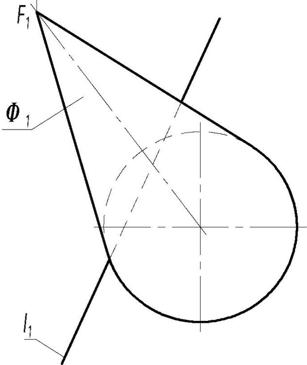
Определить точки  $K^1$  и  $K^2$  пересечения прямой  $l$  с поверхностью конуса  $\Phi$ .
