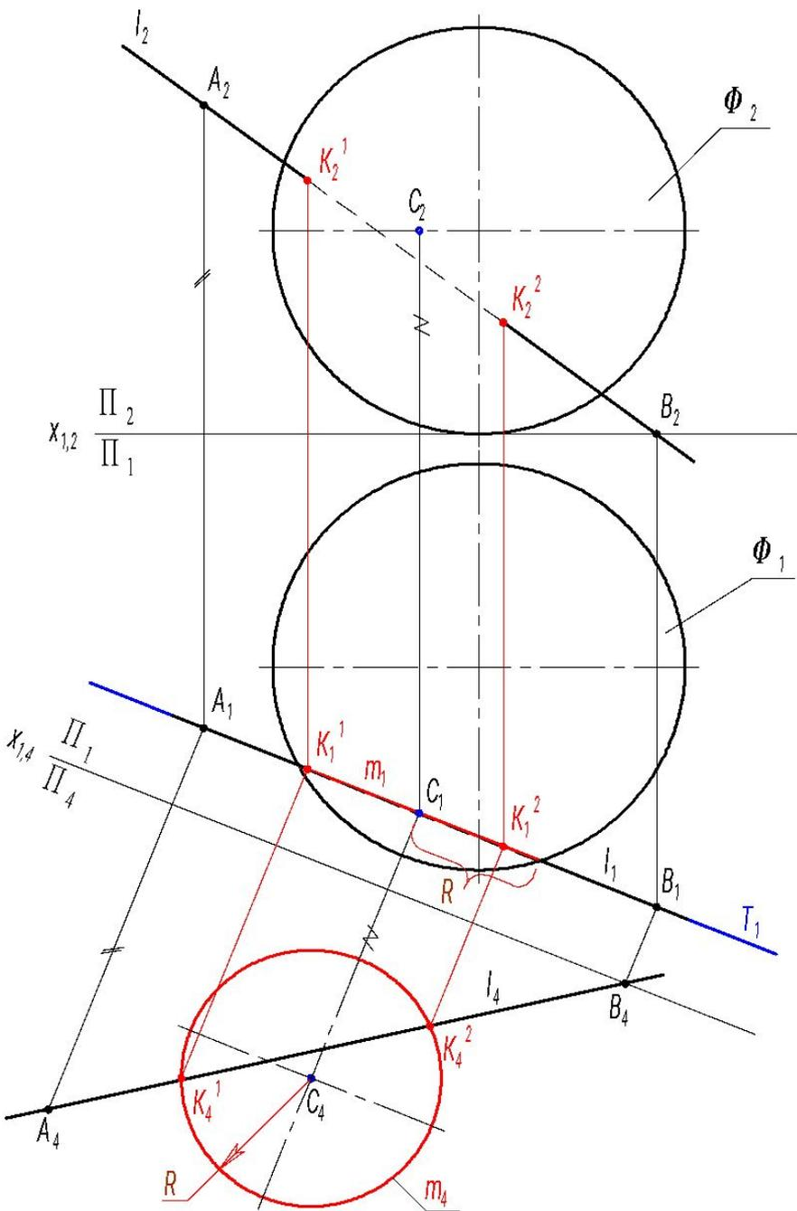
В качестве вспомогательной секущей плоскости выбираем горизонтально-проецирующую плоскость  $T$ .
