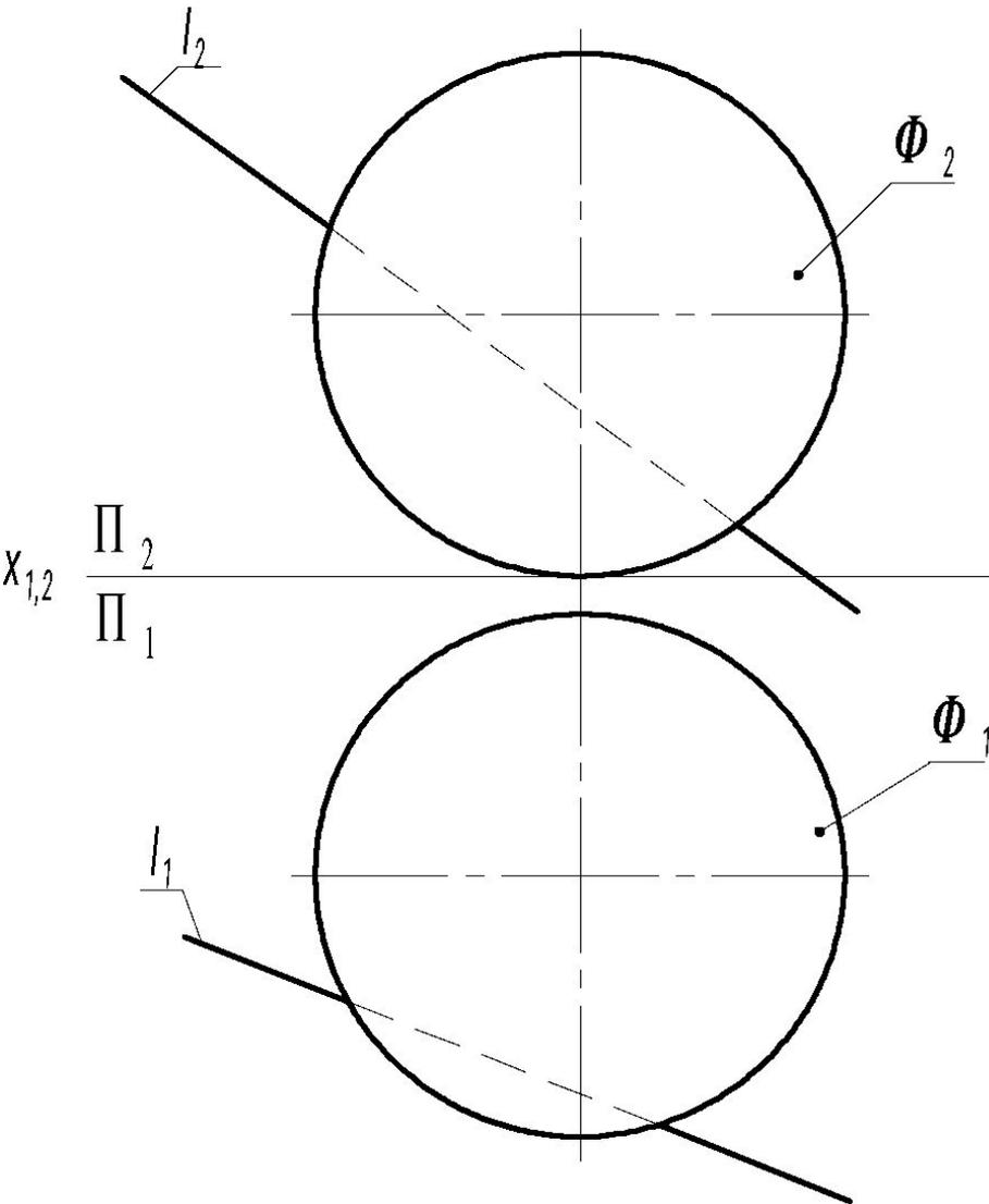
Совмещаем горизонтальную проекцию  $m_1$  линии  $m$  с горизонтальной проекцией прямой  $l$ .
