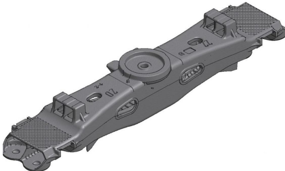
Надрессорная балка делается стальной, цельнолитой. Выполнена в форме бруса, с подпятником и полкой для крепления кронштейна мертвой точки рычажной передачи тормоза, опорами для скользуна, выемками для размещения фрикционных клиньев, буртами и выступами, удерживающими наружные и внутренние пружины от смещения при движении тележки.
