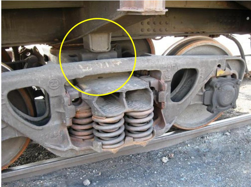
**Скользуны тележки являются боковыми опорами кузова. Состоят из опор, отлитых заодно с надрессорной балкой, колпаков, надетых на опоры, прокладок для регулировки зазоров между скользящими рамой вагона и тележки, болта, предохраняющего колпак от падения. Зазор между скользящими для основных типов четырехосных вагонов должен быть в пределах 6-16 мм.**
