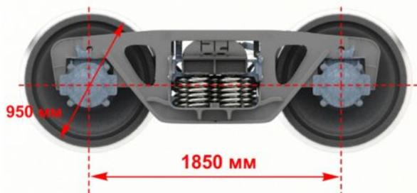
Габаритные размеры тележки
