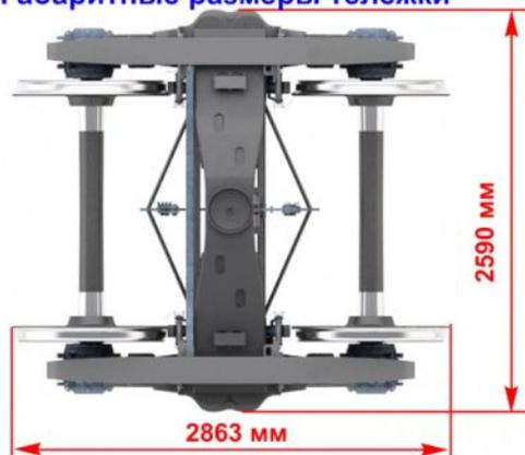
Габаритные размеры тележки
