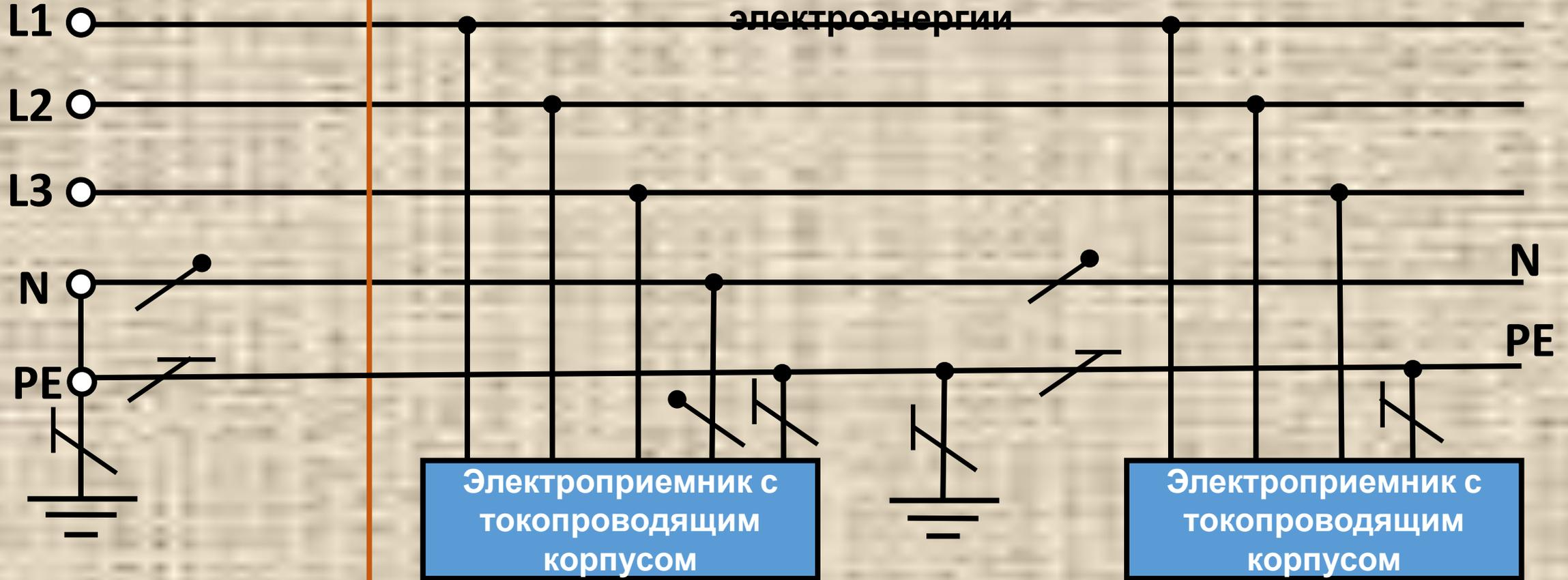
Нулевой рабочий и нулевой защитный проводники проложены отдельно. Заземлитель установлен и на стороне потребителя. При использовании встроенной (пристроенной) трансформаторной подстанции питания можно использовать заземлитель этой подстанции. Схема используется во вновь создаваемых сетях. Необходимо следить за соблюдением назначения проводников PE и N. Обратные токи по шине PE – исключены.
