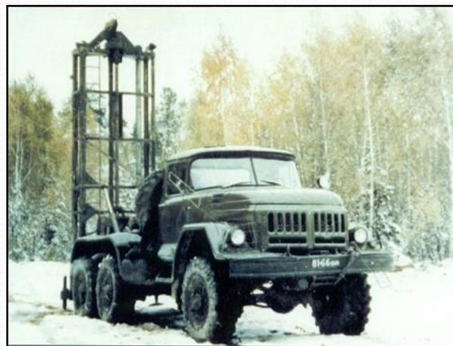
5. **УРБ-3-АМ** (установка роторного бурения) используется для устройства постоянных скважин глубиной до 250 м.
