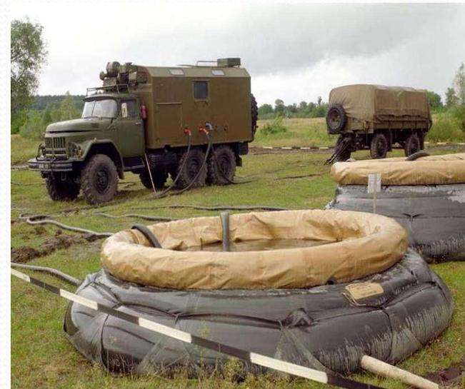
4. **ОПС** (опреснительные передвижные станции) предназначены для опреснения воды. При наличии в воде радиоактивных веществ одновременно с опреснением происходит удаление взвешенных радиоактивных частиц и уменьшение содержания растворённых радиоактивных веществ. Производительность при очистке - 8м<sup>3</sup>, при опреснении - 3-6м<sup>3</sup> воды в час.
