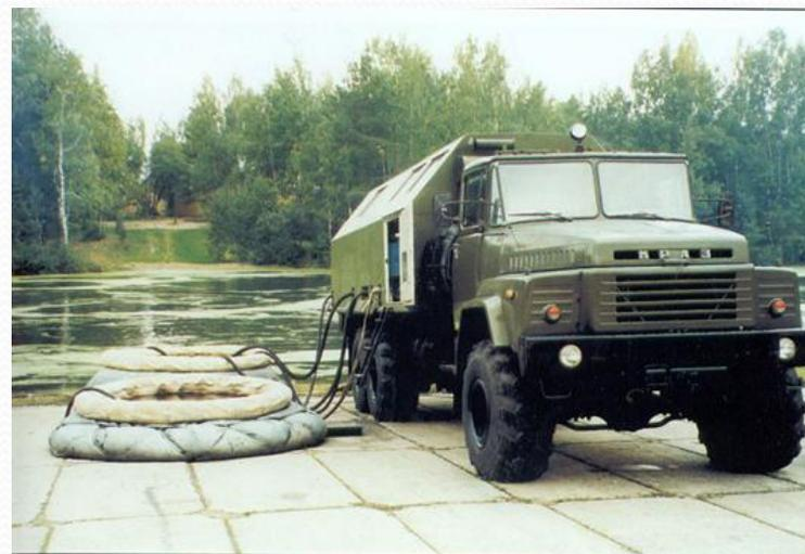
5. **СКО** (станции комплексной очистки) предназначены в рамках единой технологической схемы для очистки воды от естественного загрязнения, её обеззараживания, дезактивации, дегазации и опреснения. Производительность около 8м<sup>3</sup> воды в час.
