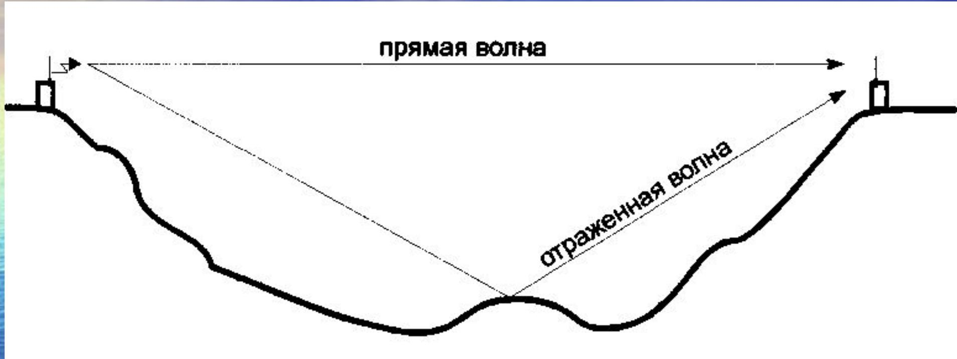
Избежать **интерференции** радиоволн можно выбором места развертывания станции, а если это сделать невозможно, то изменением рабочей частоты.
