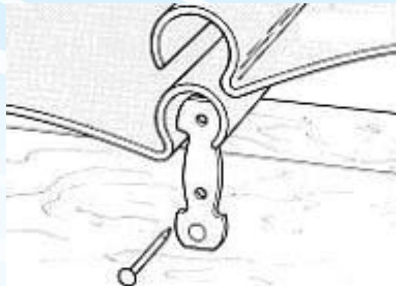
Пластины прикрепляются к рёбрам обрешётки по каждому шву с помощью металлических фиксаторов (их расход - около 10 шт/м<sup>2</sup>)
