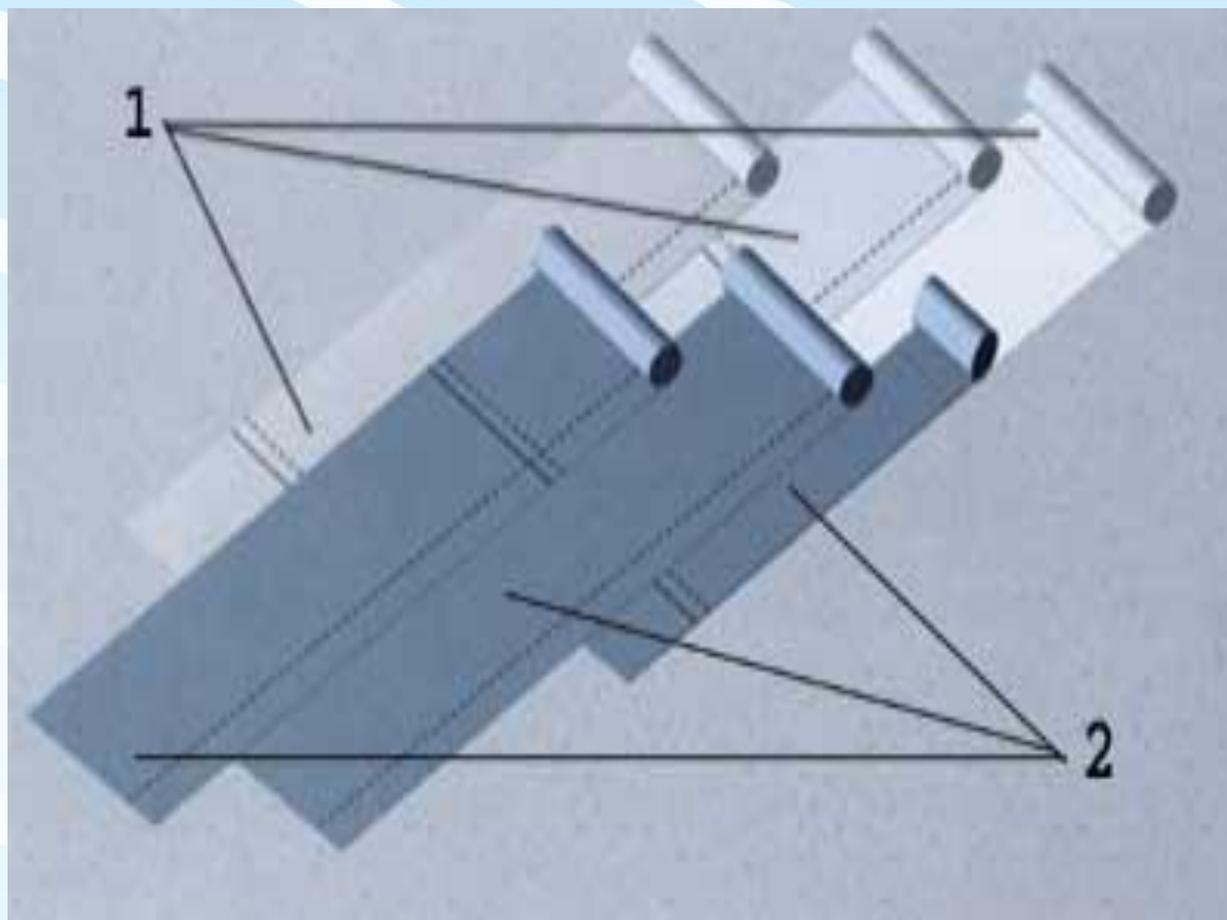
**Схема укладки битумного рулонного материала:**
