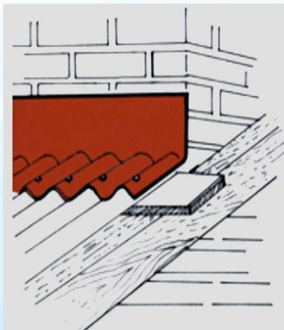
На торцевом стыке кровли с вертикальной стеной (например: с печной трубой) можно использовать покрывающий фартук Onduline. Стык покрывающего фартука с вертикальной стеной необходимо надежно гидроизолировать. Прибивать покрывающий фартук к листу необходимо по каждой волне
