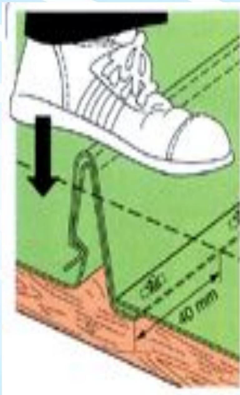
Существует еще одна современная разновидность фальцевой кровли: из специальных стальных панелей с **самозащелкивающимися фальцами**. Такие фальцы соединяют друг с другом, не применяя специальный инструмент. Ниже приведены краткие указания по технологии устройства кровли из панелей с самозащелкивающимися фальцами.
