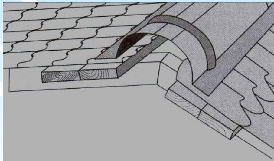
Для устройства **обрешетки** по стропилам на уложенный гидроизоляционный материал прибиваются спадающие бруски 25x50мм, а к ним антисептированные доски обрешетки 32x100мм с шагом между ними 350 или 400мм, соответствующим шагу поперечного гребня металлочерепицы.
