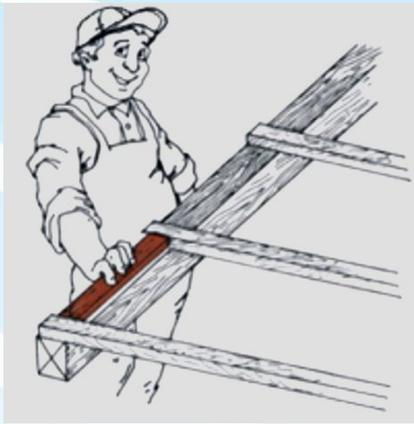
Бруски обрешетки должны быть прибиты к стропилам на определенном расстоянии по осям, при этом нужно пользоваться деревянным "интервалом" для соблюдения параллельности обрешетин
