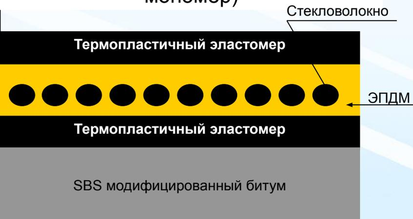
Структура ЭПДМ мембраны. Слой термопластичного эластомера, обеспечивающего уникальную технологию скрепления швов
