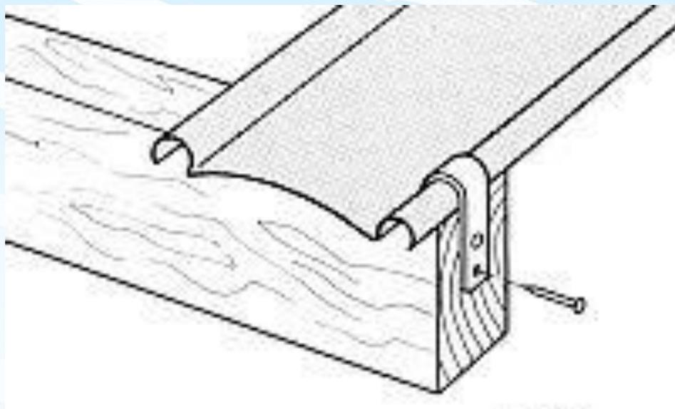
Крайние пластины покрытия закрепляют к концам каждого ребра с помощью боковых фиксаторов
