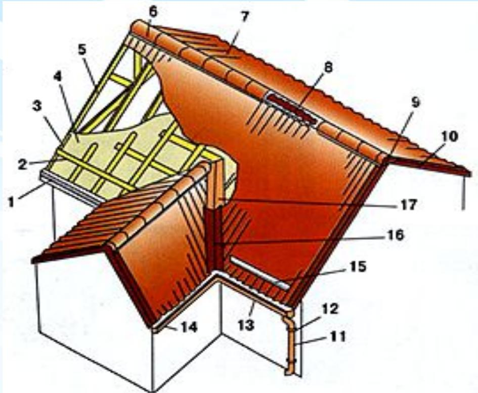
Схема кровли из металлочерепицы.
