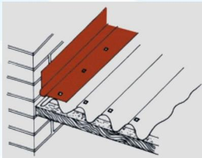
Оформить боковой стык кровли с вертикальной стеной можно при помощи ендовы Onduline, который затем необходимо гидроизолировать
