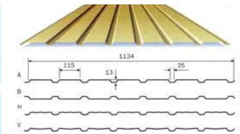
В отличие от фальцевой кровли, где крепление листов к обрешетке происходит с помощью кляммеров в фальцах, профилированные листы укладывают внахлест друг на друга, и крепят к брускам обрешетки при помощи саморезов в нижнюю гофру. Для этого обязательно использование саморезов с герметизирующими прокладками.
