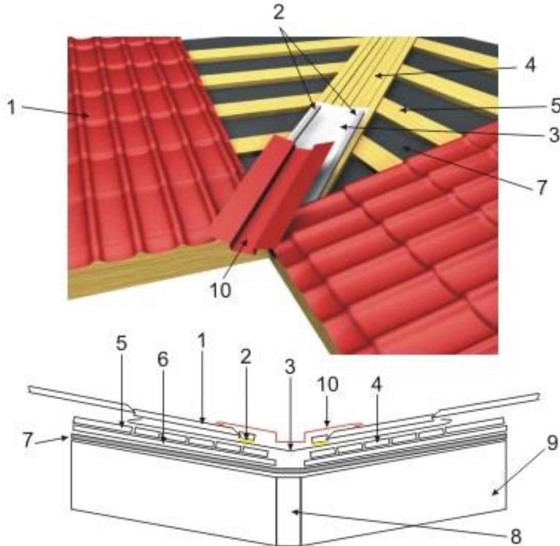
**Монтаж ендовы.** 1 - Кровельный лист; 2 - уплотнитель универсальный; 3 - внутренняя ендова; 4 - деревянный настил; 5 - обрешетка; 6 - брусок обрешетки; 7 - гидроизоляция; 8 - опорный узел; 9 - стропило; 10 - внешняя ендова
