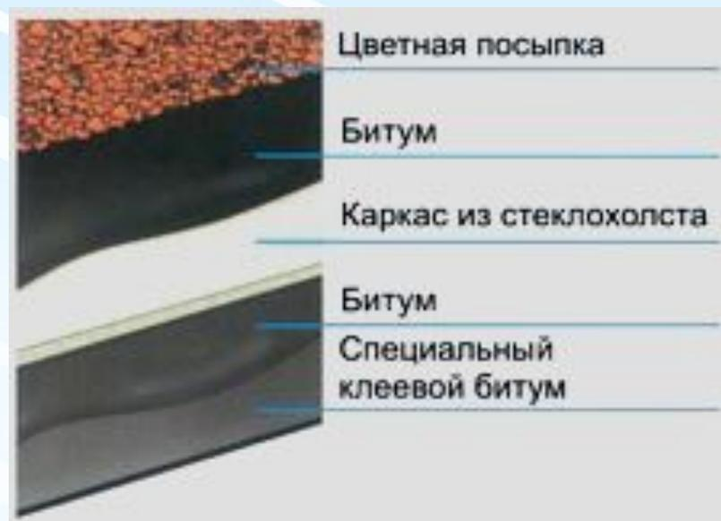
Структура полотна рулонного материала «ИЗОПЛАСТ» (завод ИЗОФЛЕКС).
