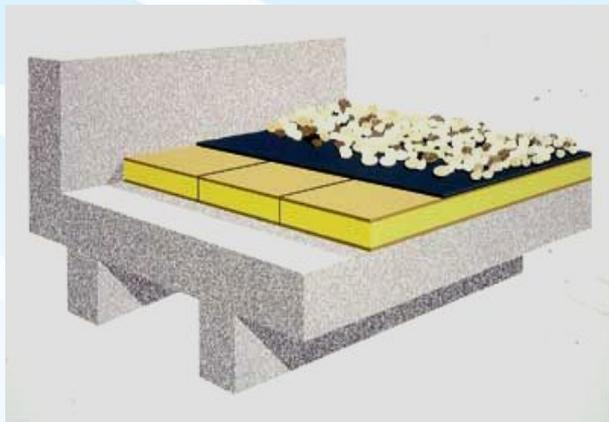
**Балластная система фирмы FIRESTONE.** Листы свободно укладываются на основании, швы соединяются таким образом, чтобы сформировать непрерывную водонепроницаемую мембрану. Мембрана закрепляется только по периметру и по местам примыканий, а на поверхности основания она удерживается с помощью балласта: гальки, гравия, щебня, бетонных блоков или тротуарной плитки
