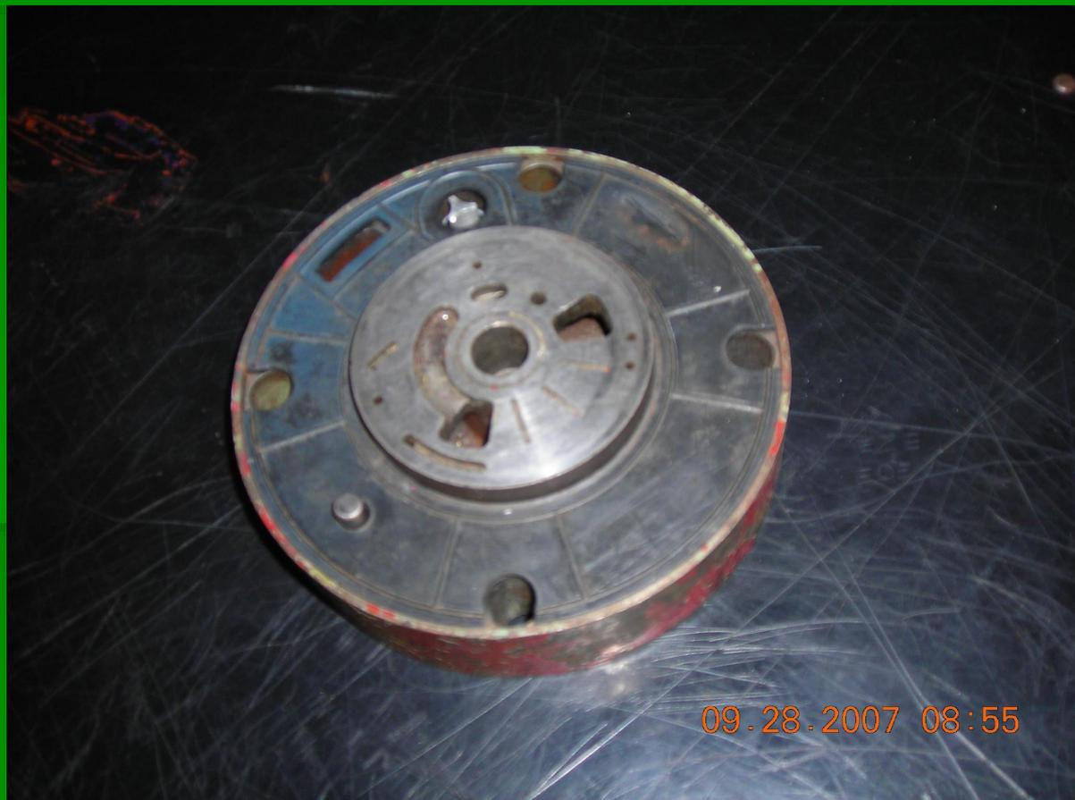
**Кулачок, нагруженный пружиной, расположенной внутри ручки крана, прижимается к прорезям на корпусе верхней части, благодаря чему ручка может иметь шесть фиксированных положений**
