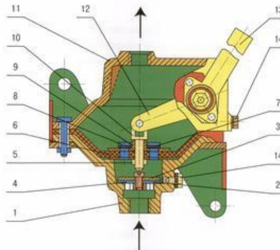
1, 11. Корпус. 2. Шайба резиновая. 3. Шайба металлическая. 4. Латунный винт. 5. Латунная гайка. 6. Мембрана. 7. Резиновая шайба. 8. Металлическая шайба. 9. Бронзовая втулка. 10. Тяга. 12. Рычаг. 13. Рукоятка. 14. Сливная пробка.
