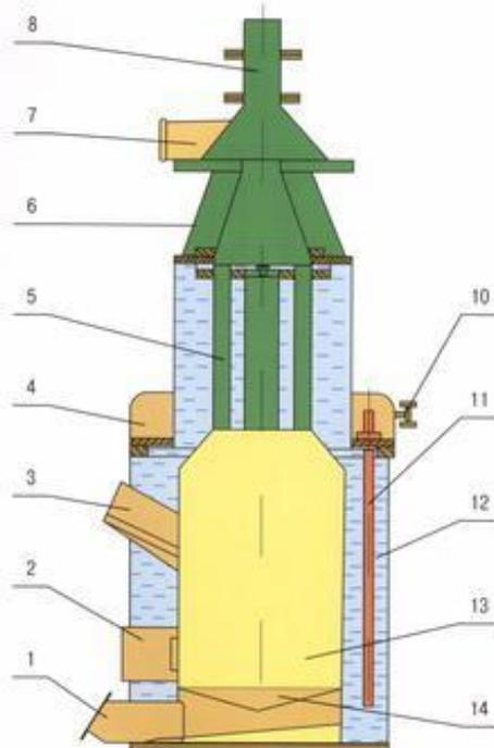
1. Зольник. 2. Шуровочный лок. 3. Лок топки. 4. Кожух. 5. Газоход. 6. Кожух газохода. 7. Прерыватель тяги. 8,9. Дымовая труба. 10. Водоотвод. 11. Нагревательные элементы. 12. Наружная рубашка. 13. Топочная камера. 14. Колосниковые решетки.
