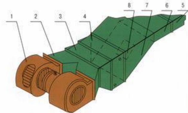
1. Сдвоенные вентиляторы с электродвигателем. 2. Диффузор. 3. Патрубок. 4. Калорифер. 5. Компенсирующая вставка. 6. Зено воздуха. 7. Конфузор. 8. Люк для очистки воздуховода.
