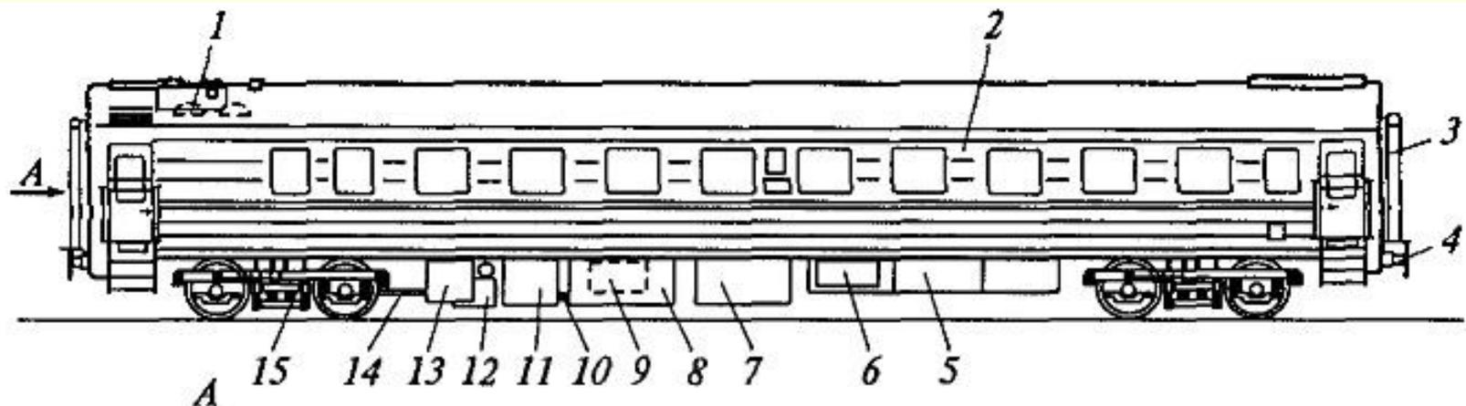
1 — дефлектор; 2 — кузов с термоизоляцией; 3 — суфле переходных площадок; 4 — буфера; 5 — аккумуляторная батарея; 6 — ящики для белья; 7 — компрессорный агрегат установки кондиционирования воздуха; 8 — конденсаторный агрегат; 9 — приборный ящик низкого напряжения; 10 — выпрямитель; 11 — трансформатор; 12 — подвагонный генератор мощностью 32 кВт; 13 — подвагонный ящик приборов высокого напряжения; 14 — привод генератора; 15 — тележка; 16 — автосцепка; 17 — междувагонное высоковольтное соединение
