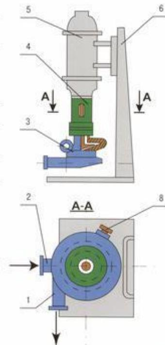
1. Нагнетательный корпус. 2. Всасывающий корпус. 3. Циркуляционный насос. 4. Переходная втулка. 5. Электродвигатель. 6. Кронштейн. 7. Крыльчатка. 8. Пробка.
