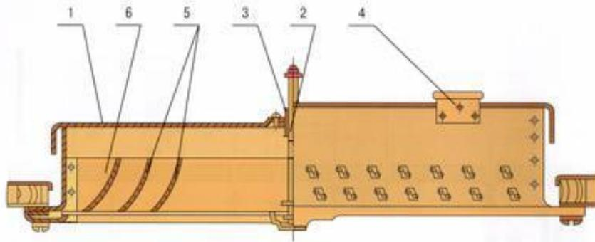
1. Крышка 2. Винт 3. Снецайка 4. Петля 5. Лопатки 6. Корпус
