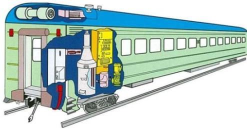
Вагон — мощный потребитель электроэнергии: мощность подвагонного генератора — 32 кВт, мощность, потребляемая котлом отопления, — 48 кВт.
