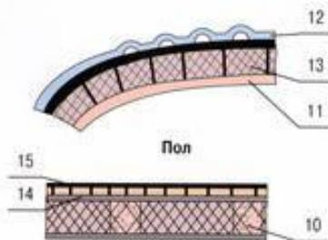
ФРАГМЕНТЫ ИЗОЛЯЦИИ И ОБШИВКИ КУЗОВА
